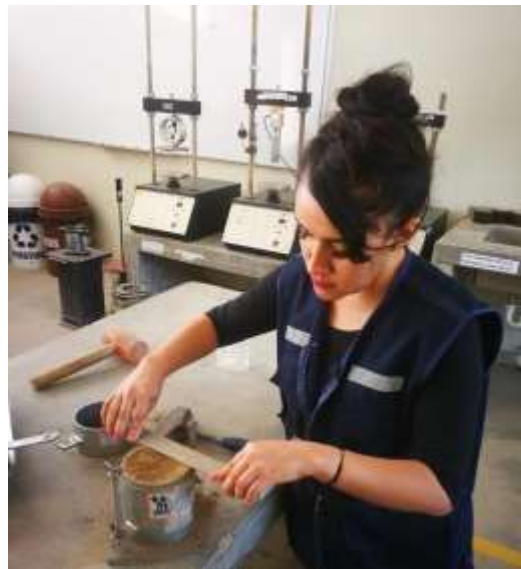
Figura 41: Ensayo de proctor modificado, laboratorio UPN
