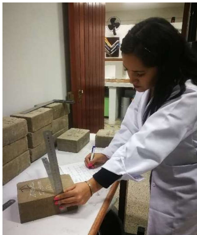
Figura 43: Medición de adobes para ensayo de esfuerzo a la compresión
