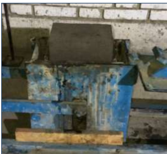
Figura 18: Adobe prensado en máquina CINVA RAM
