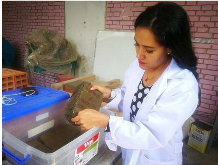
Figura 46: Retiro de adobes del ensayo de durabilidad. Taller de Materiales
