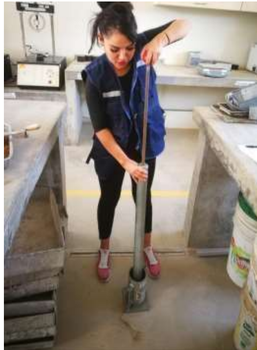
Figura 40: Ensayo de proctor modificado - Laboratorio UPN
