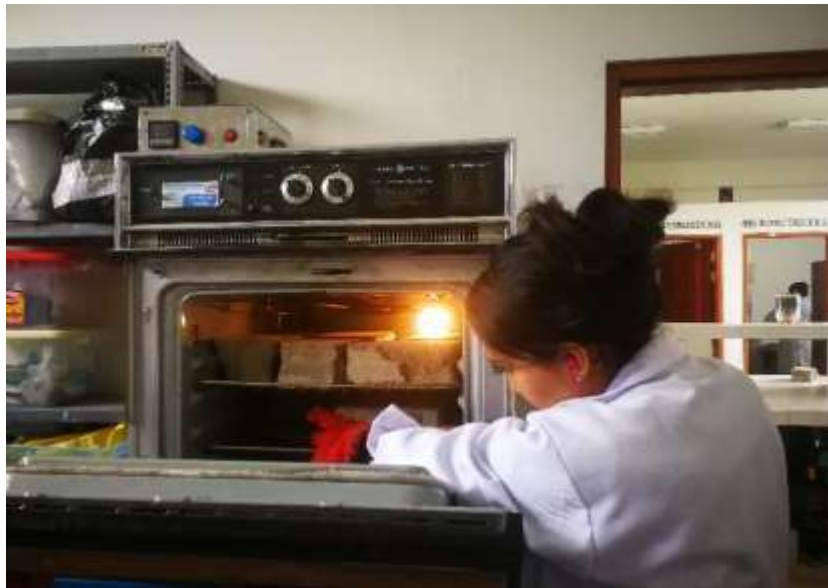
Figura 47: Secado al horno de adobes después de ensayo de durabilidad
