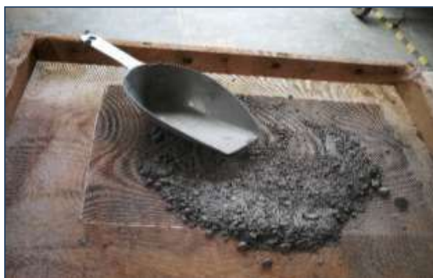
Figura 12: Tamizado de ceniza por malla N°200
