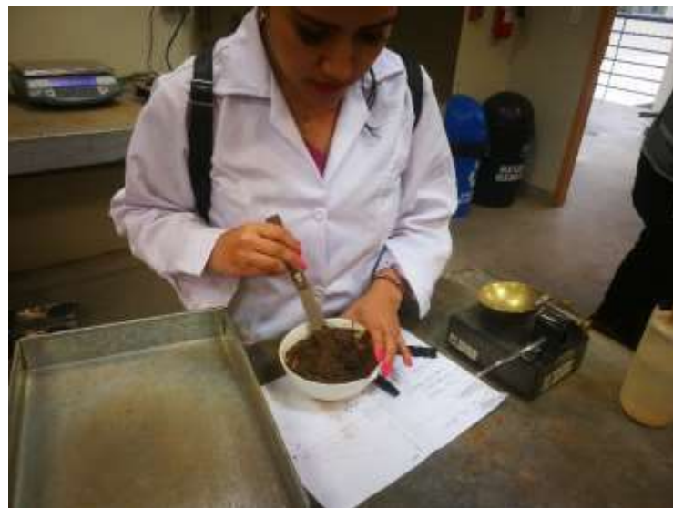
Figura 39: Ensayo de casa grande - Laboratorio UPN
