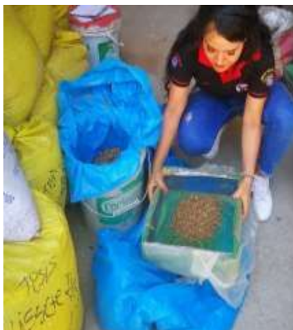
Figura 11: Tamizado de tierra originaria de campiña de moche
