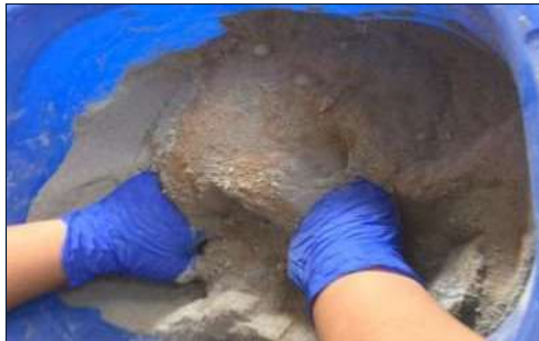
Figura 16: Mezcla de materiales: tierra, ceniza y cemento
