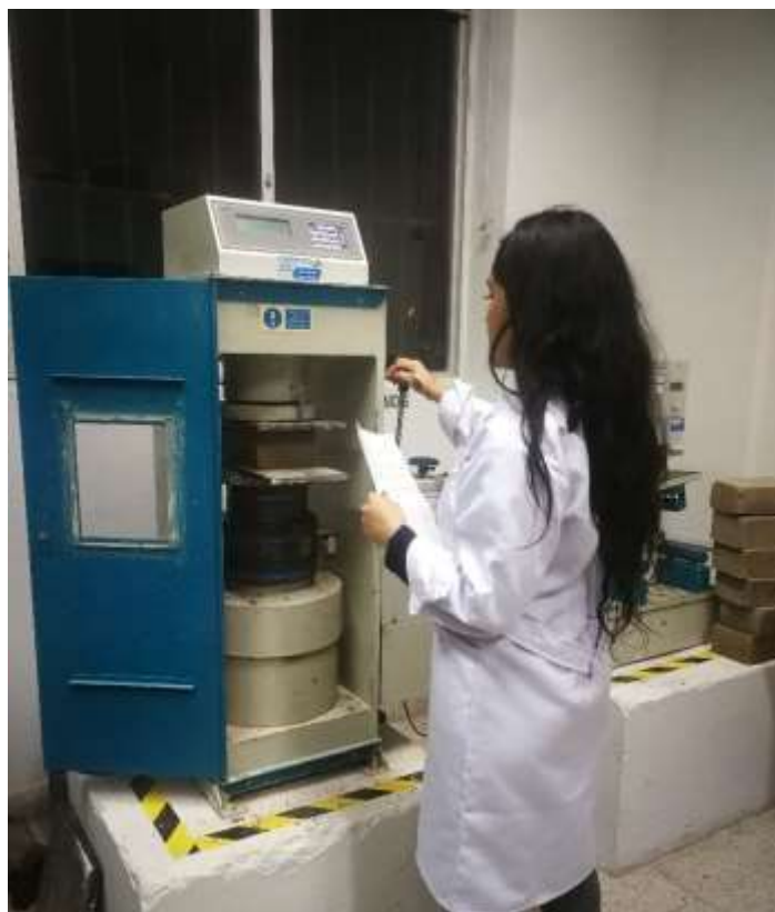
Figura 44: Ensayo de esfuerzo a la compresión. UNT
