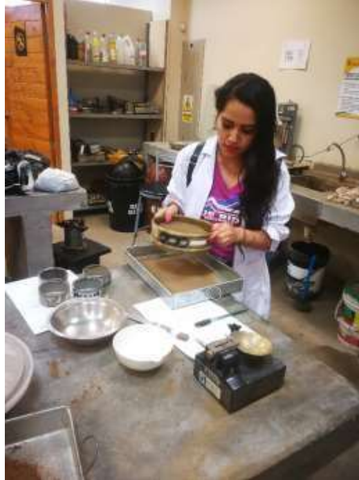
Figura 38: Ensayo de límites de atterberg - Laboratorio UPN
