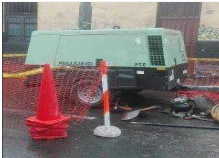
*Figura N°43:* Compresora SULLAIR de 375 PCM
