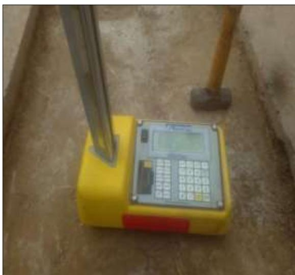
*Figura N°18:* Densímetro Nuclear Norma ASTM D-2922.
