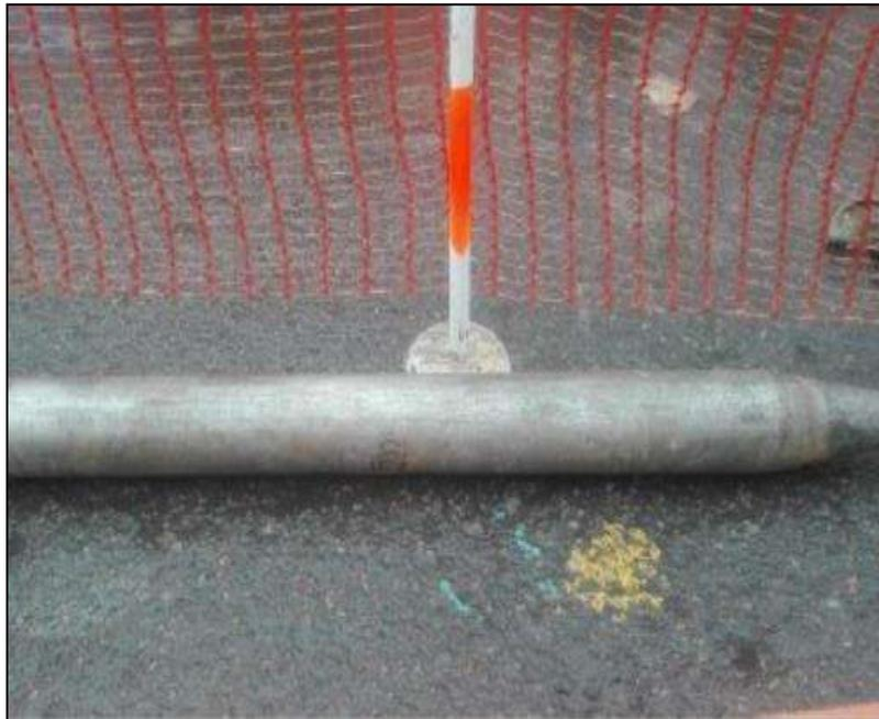
*Figura N°42:* Topo neumático modelo 5 ¾”
