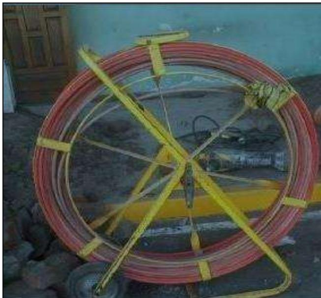
*Figura N°45:* Pasacables tipo Cobra de 150 ml
