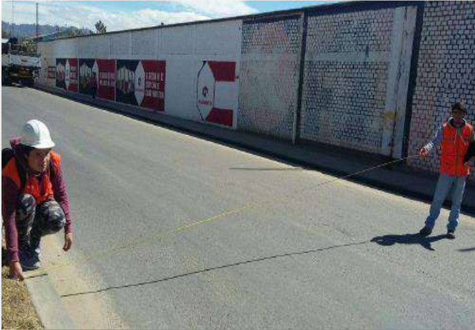
Figura 72. Medición de la sección de la carretera en donde se realizó la contabilización.
