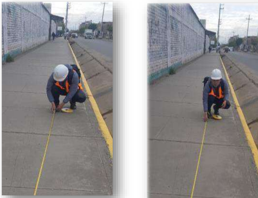
Figura 74. Ubicación del punto inicial y final para la determinación de velocidades (300m)
