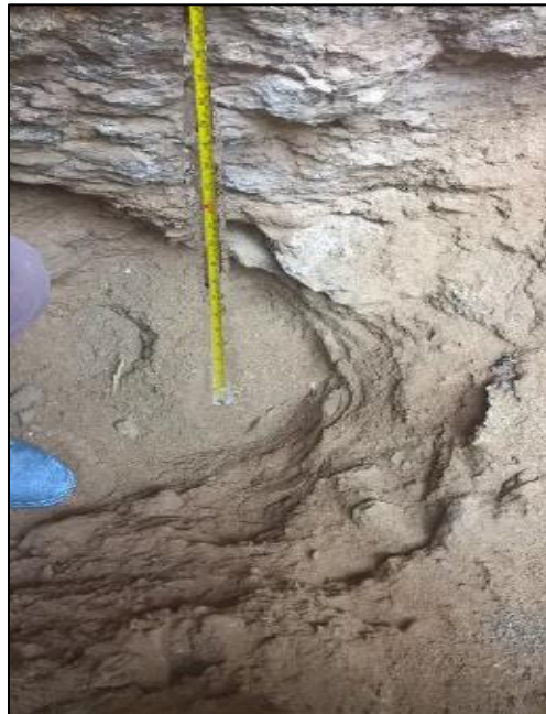
Figura 12: Registro e identificación de estratos que conforman el subsuelo
