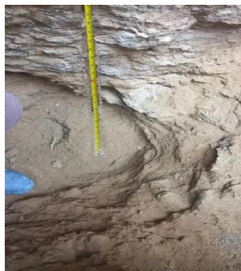
Figura 35: Registro e identificación de estratos que conforman el subsuelo
