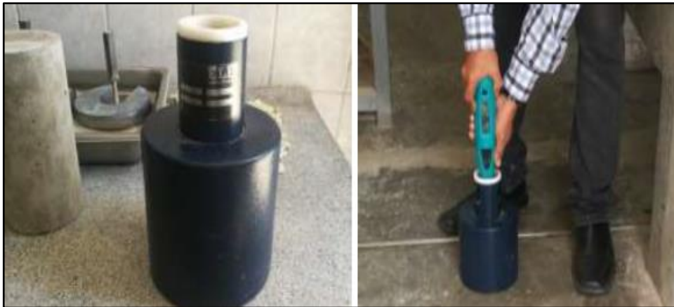
Figura 26: Yunque de verificación de calibración del esclerómetro
