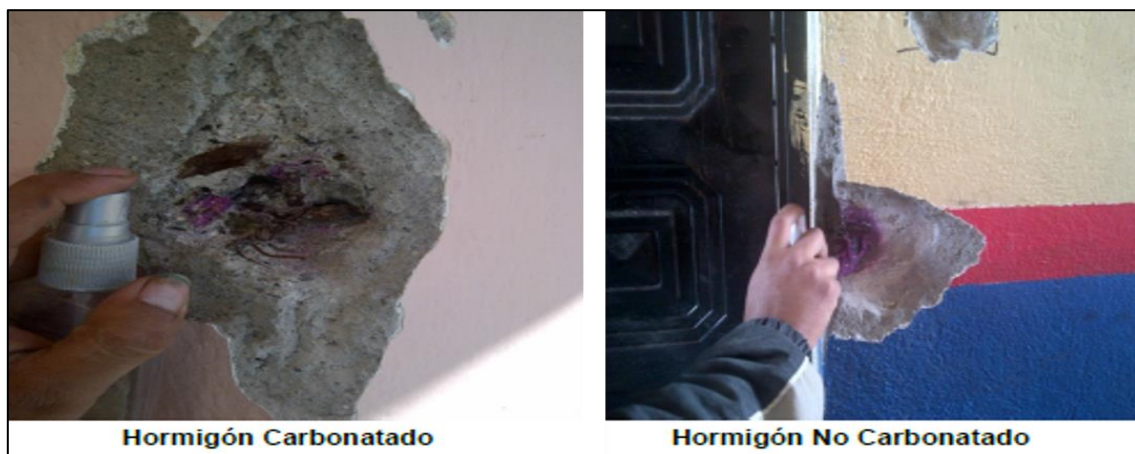
Figura 24: Ensayos de carbonatación realizados en elementos estructurales
