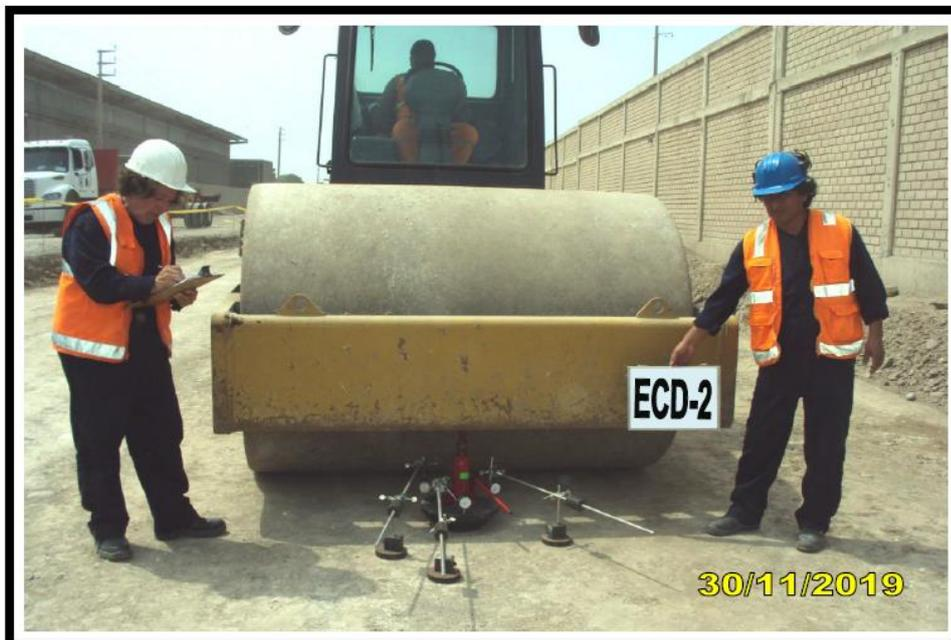
*Figura 64.* Ensayo de carga directa 2 - primera capa.
