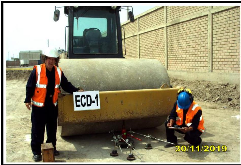
*Figura 63.* Ensayo de carga directa 1 - primera capa.
