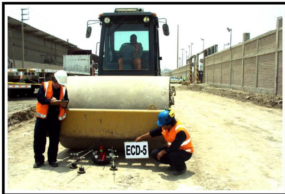
*Figura 66.* Ensayo de carga directa 5 - primera capa.
