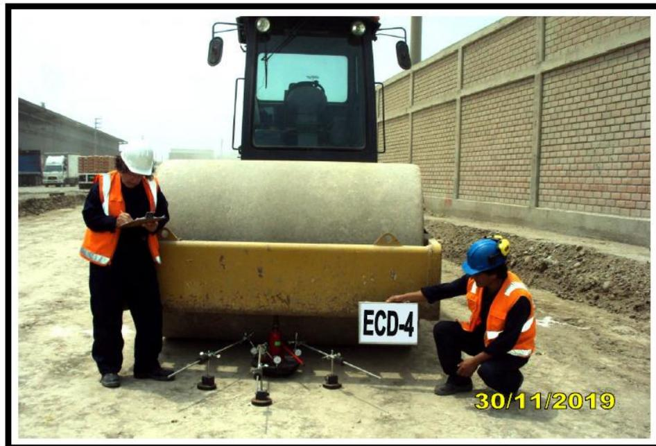
*Figura 65.* Ensayo de carga directa 4 - primera capa.
