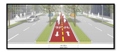
Figura 7. Ejemplo esquemático de ciclovía (bidireccional) en separador central. Fuente: Manual de Criterios de Diseño de Infraestructura Ciclo-inclusiva y Guía de Circulación del Ciclista, 2017.
