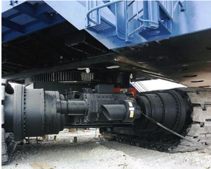
Figura 26. Sistema de propulsión de la pala eléctrica P&H 4100. Fuente: Maquinarias Pesadas (2020)
