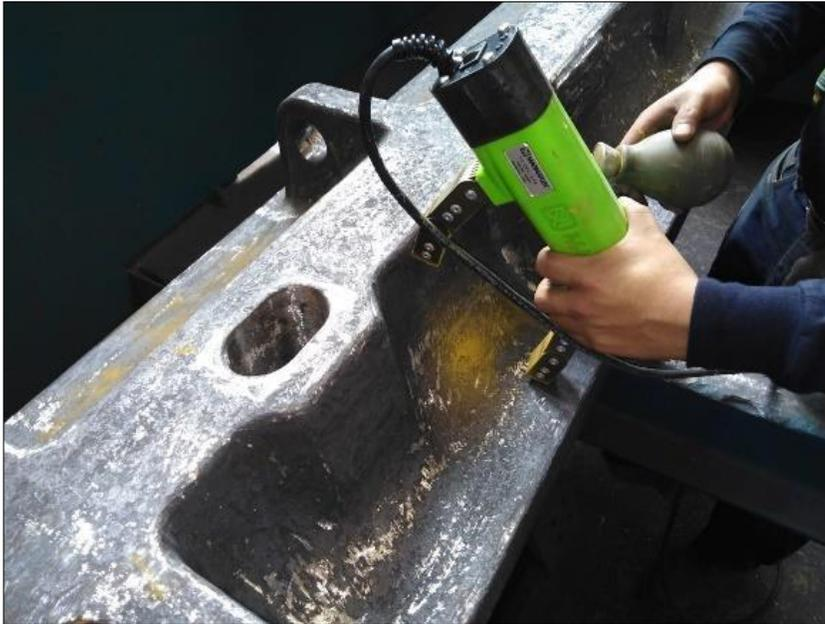
*Figura 52.* Posición de magnetizar el yugo magnético
