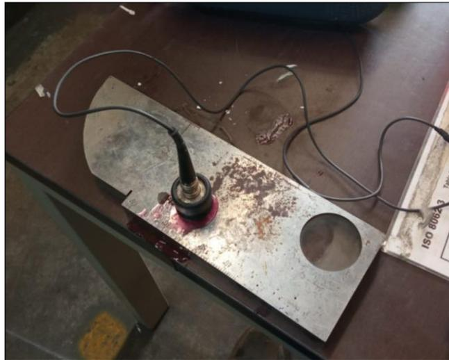
*Figura 7.* Bloque de calibración para medición de espesores por haz recto.
