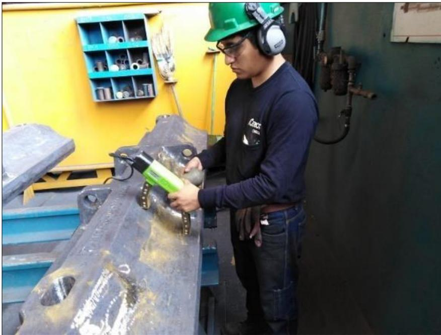
Figura 54. Vista de la zona de trabajo realizando el método de las partículas magnéticas
