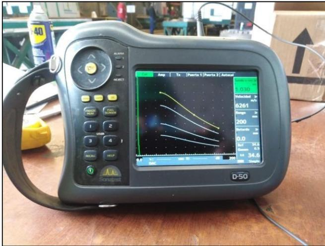
*Figura 66.* La Curva DAC en el Equipo Sonatest
