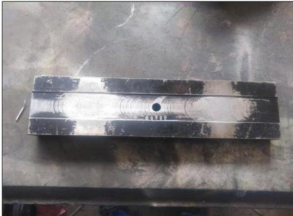
*Figura 49.* Patrón de calibración según la Norma ASTM E-709
