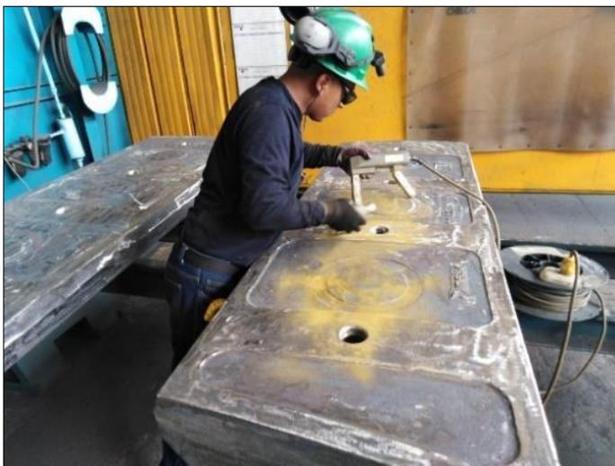
*Figura 53.* Zona magnetizada la cara de ensamble
