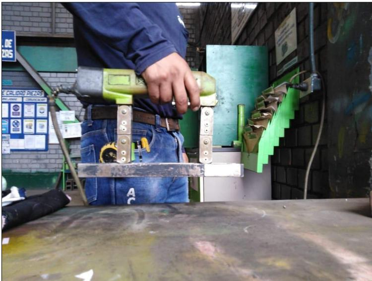
*Figura 50.* Calibración ensayo de la fuerza de izado del yugo magnético
