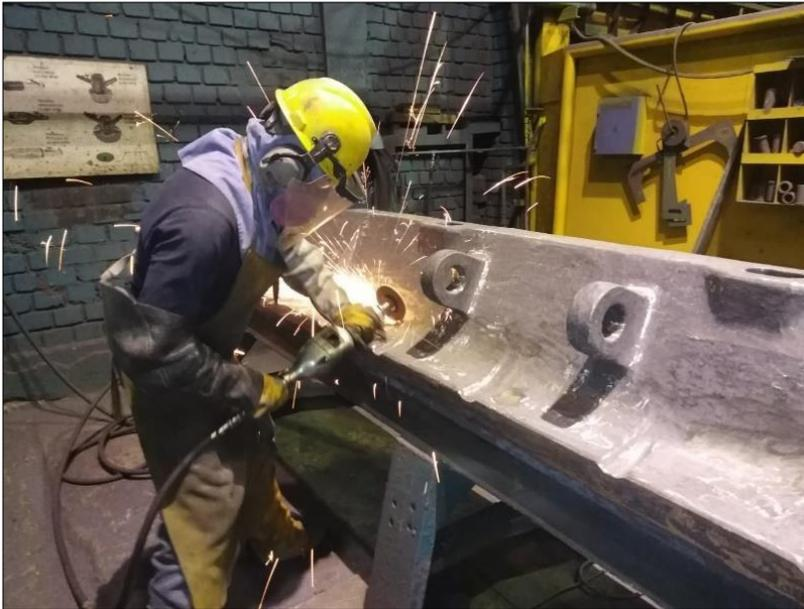
*Figura 51.* Limpieza de la zona de trabajo del forro de molino SAG
