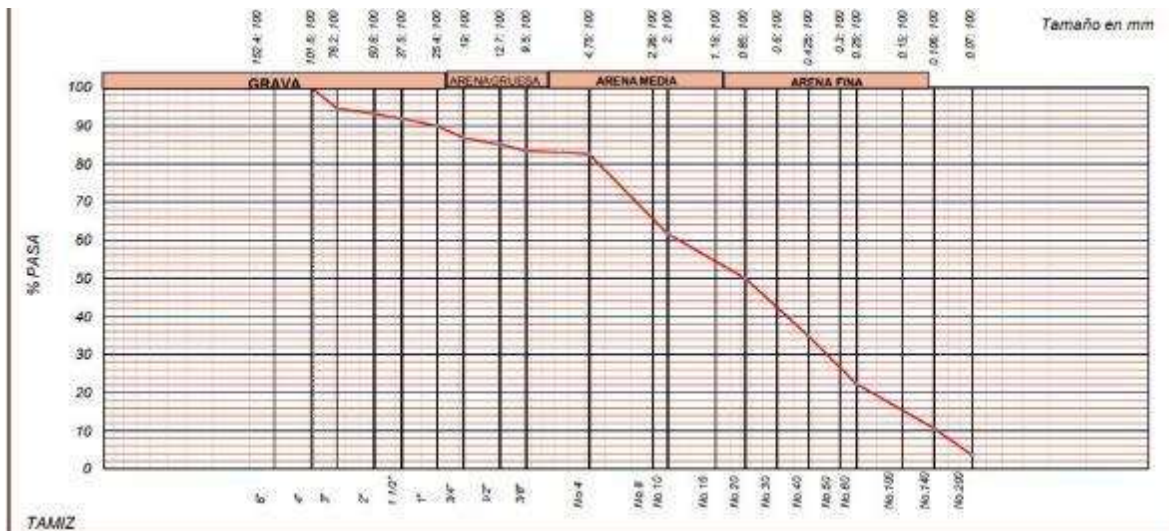
Figura 24. Granulometría de la muestra 2. Fuente: KAOLYN INGENIEROS SAC. 2018
