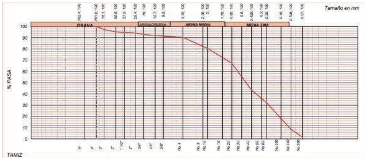
Figura 23. Granulometría de la muestra 1. Fuente: KAOLYN INGENIEROS SAC. 2018
