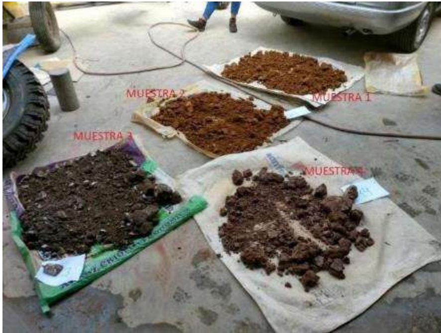
Figura 20. Preparación de las 4 muestras en el laboratorio. Fuente: Propia.
