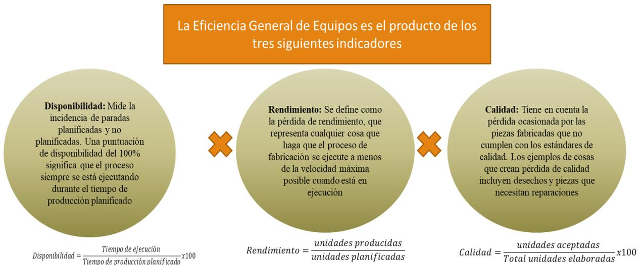
Figura 6. Estructura de la eficiencia global de equipos.
