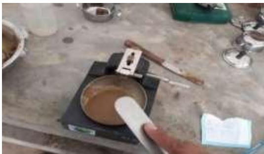
Realización de ensayos de materiales, Determinación del limite líquido (L.P.); Limite Plastico (L.P) e Indice de plasticidad (I.P) según norma (MTC E 110/ E 111)
