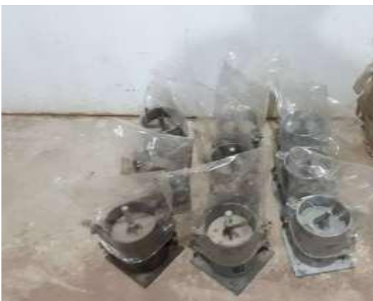
Realización de ensayo de materiales, moldeo de CBR de Mezcla para diseño suelo cemento con aceite sulfonado
