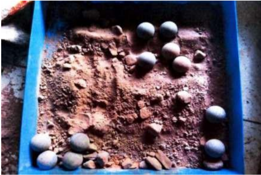
Figura 12. Abrasión los ángeles (L.A.) por desgastes de agregados 37,5mm (MTCE 207). Fuente: elaboración propia
