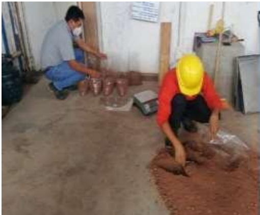
Realización de ensayo de materiales, Compactación de suelos en laboratorio utilizando una energía modificada PROCTOR MODIFICADO, método “C” Según Norma (MTC E 115)
