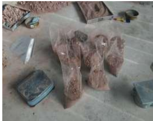
Realización de ensayo de materiales, Compactación de suelos en laboratorio utilizando una energía modificada PROCTOR MODIFICADO, método “C” Según Norma (MTC E 115)
