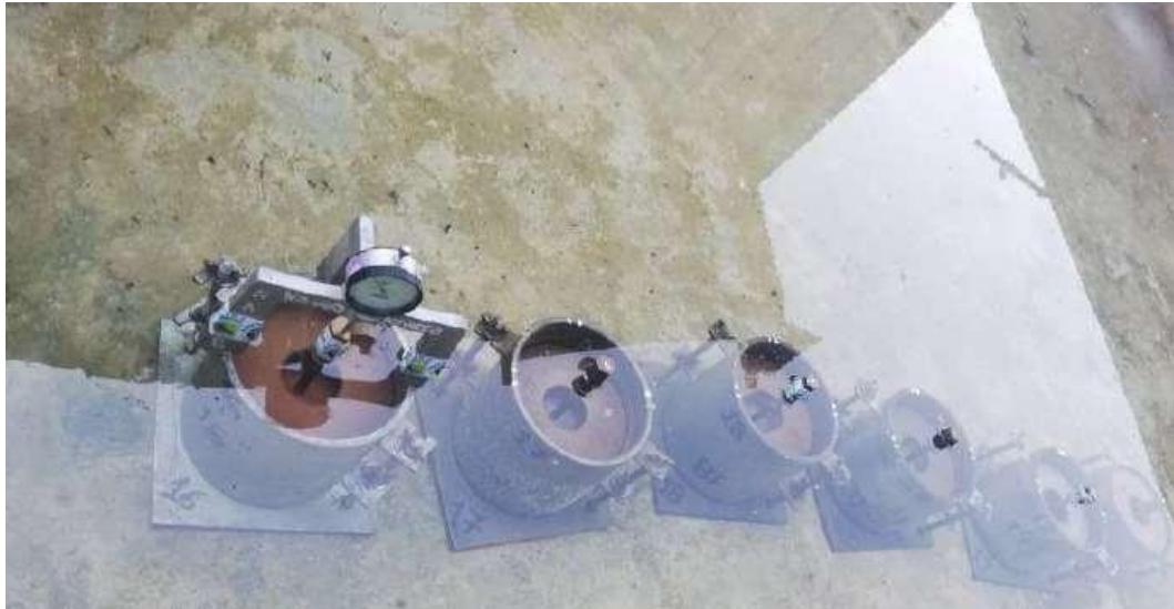
Figura 18 Inmersión de moldes y material para medir la expansión y saturación 4 días. Fuente: elaboración propia
