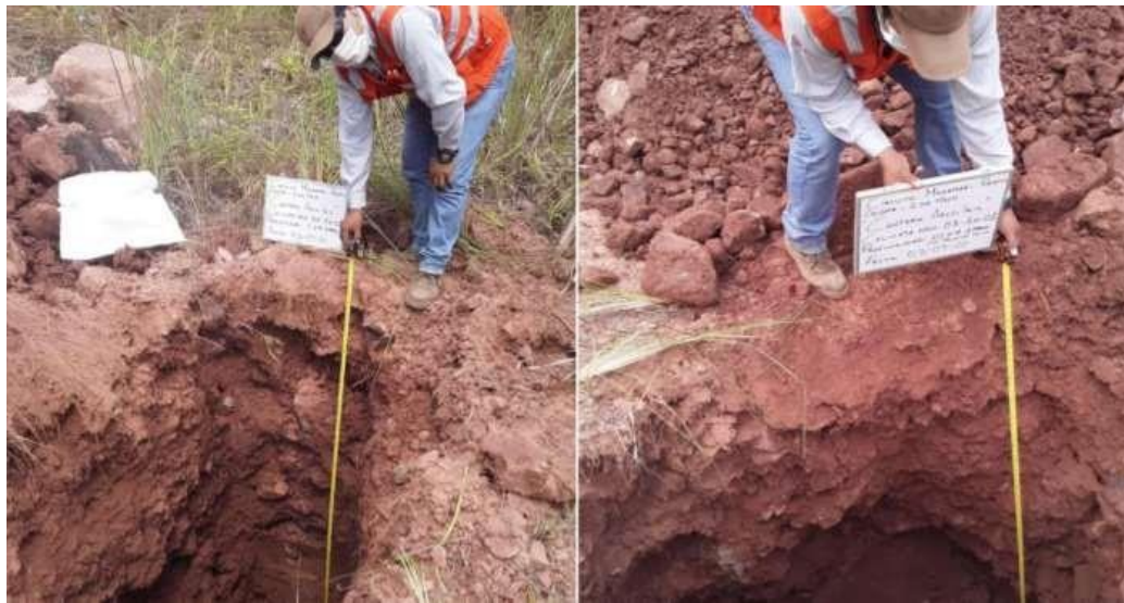
Figura 6 Muestreo de material de cantera Arco Iris Km. 50+043.79 LI. Fuente: elaboración propia
