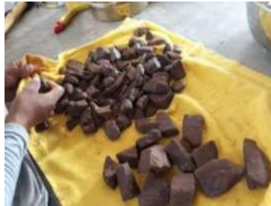
Realización de ensayos de materiales, reducción de muestras de campo a tamaños de muestras de campo (MTC E 103) y peso específico y absorción de los agregados gruesos (MTC E 206)
