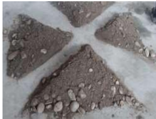
Cuarteo de materiales de canteras según reducción de muestras de campo a tamaños de muestras de campo (MTC E 103) método
