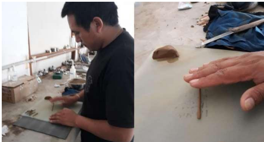
Figura 8 Ensayo para determinar el Índice de Plasticidad. Fuente: elaboración propia
