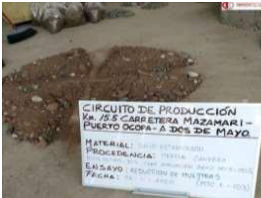
Realización de ensayos de materiales, reducción de muestras de campo a tamaños de muestras de campo (MTC E 103) y peso específico y absorción de los agregados gruesos (MTC E 206)
