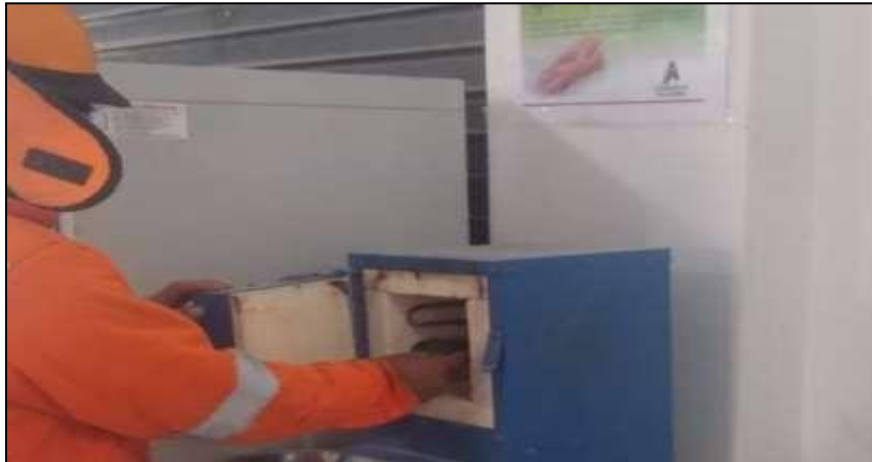
Figura 9 Materia orgánica en suelos mediante el método de pérdida por ignición (MTC E 118)
