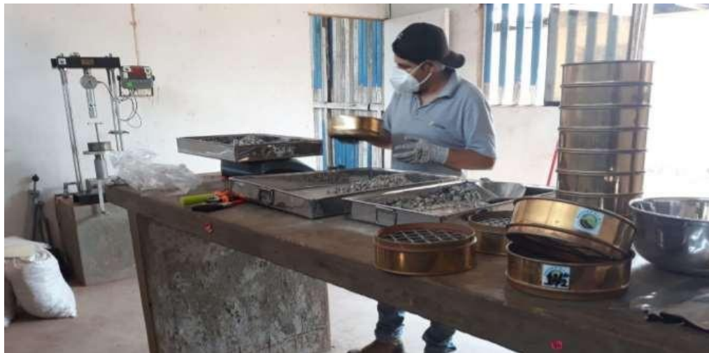
Figura 7 Ensayo Análisis granulométrico por tamizado. Fuente: elaboración propia
