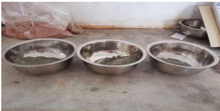
Figura 16. Selección de diferente porcentaje de cemento 1.5% ,2%,2.5%. Fuente: elaboración propia
