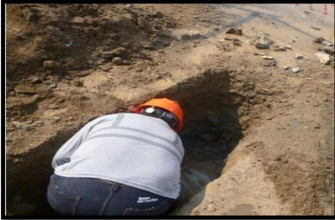
Figura 48. Calicata al resultado del mejoramiento de suelo con afirmado y cloruro de calcio.
