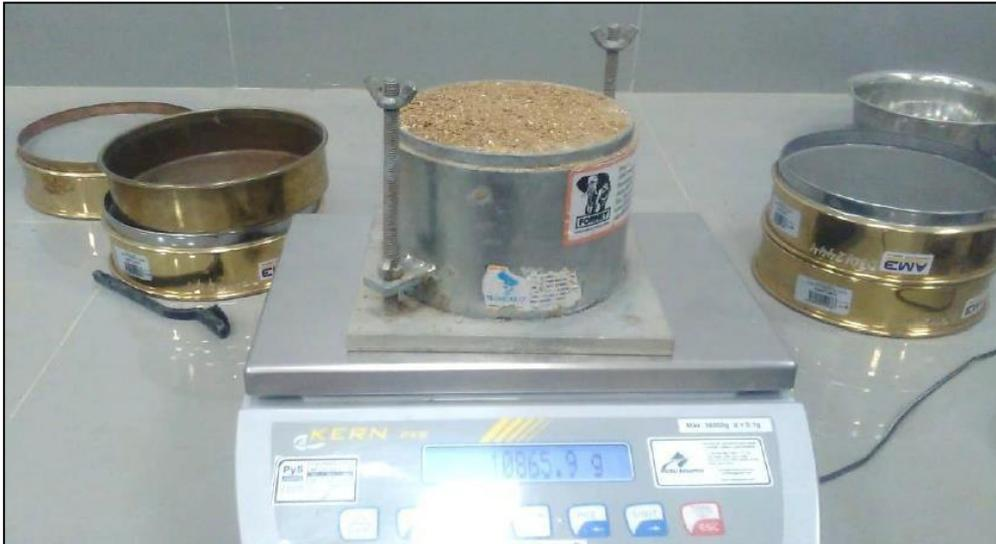
Foto 7. Pesando la muestra del Proctor Modificado.
