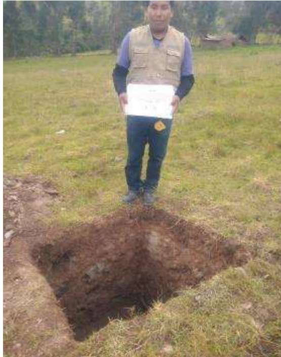
Figura B. N° 9: Profundidad de la calicata C-1 = 1.80m.
