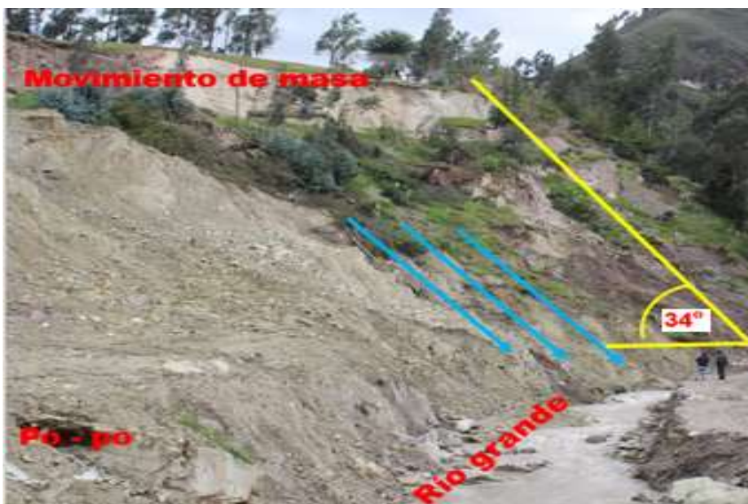
Figura N° 20. Posible deslizamiento de masa al rio grande
