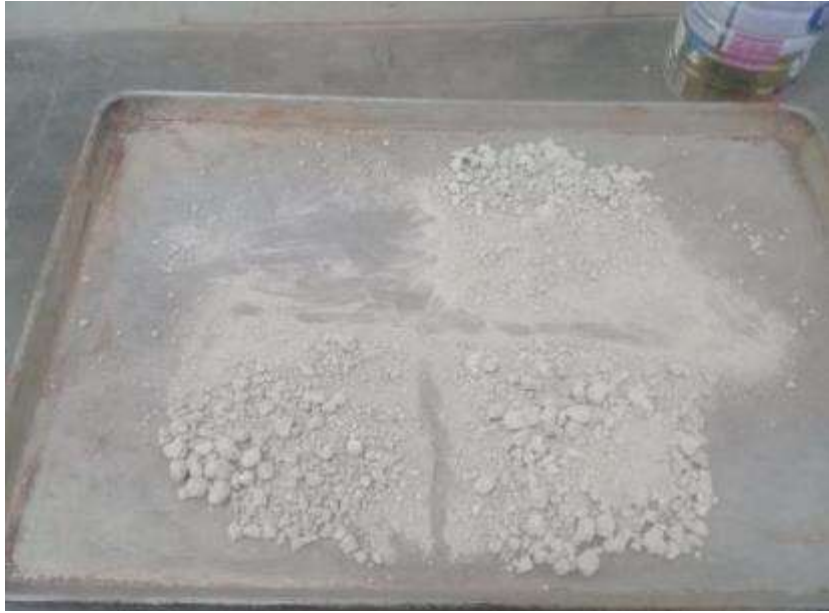
Figura B. N° 11: Cuarteo de la muestra, C-2
