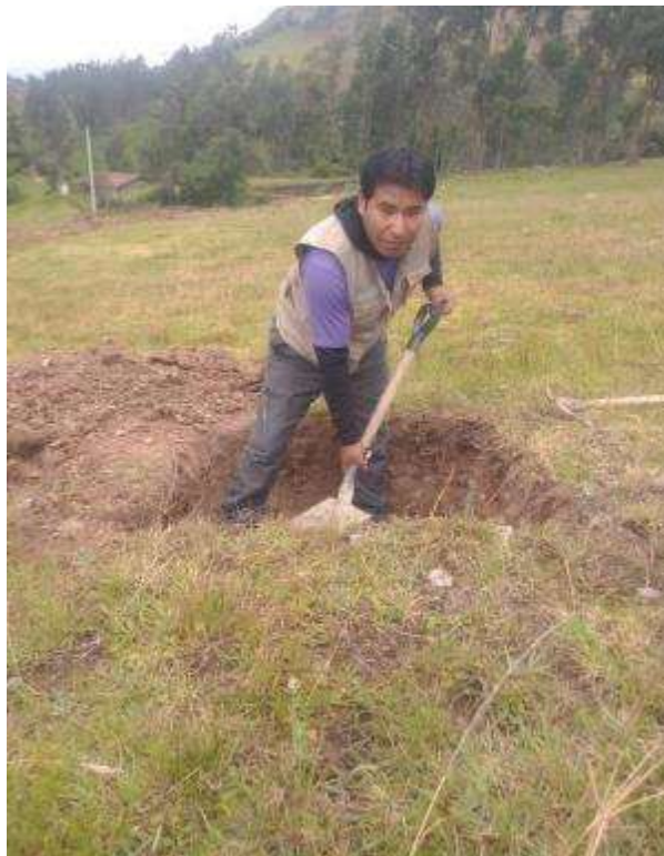
Figura B. N° 8: Exploración de las calicatas.
