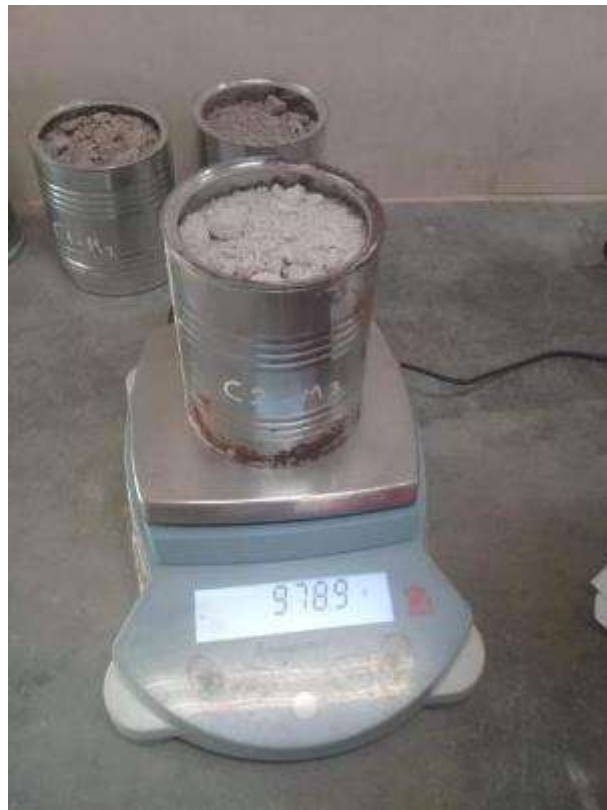
Figura B. N° 12: Peso de la muestra C-2.
