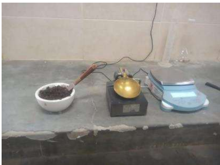
Figura B. N° 14: Copa de Casagrande y la muestra.
