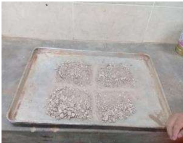
Figura N° 3: Cuarteo y preparación de muestra.
