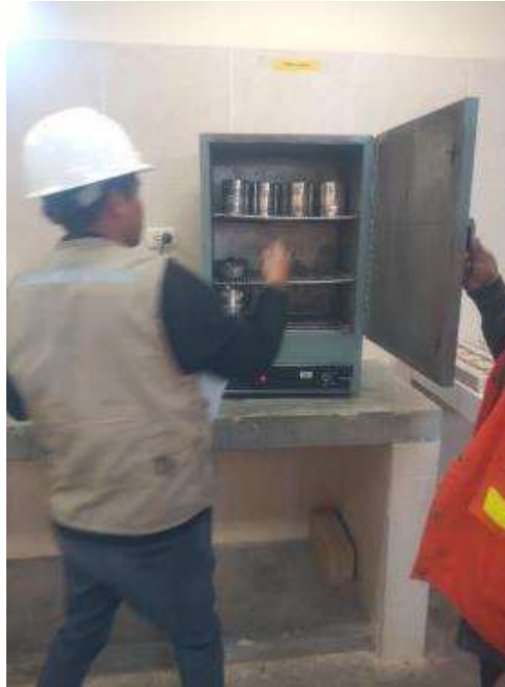
Figura B. N° 17: Secado en el horno 110 \pm 5 °C
