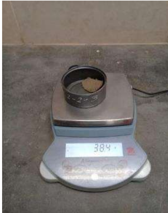
Figura B. N° 15: Determinación del límite líquido.
