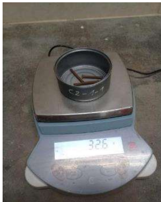
Figura B. N° 16: Determinación del límite plástico.
