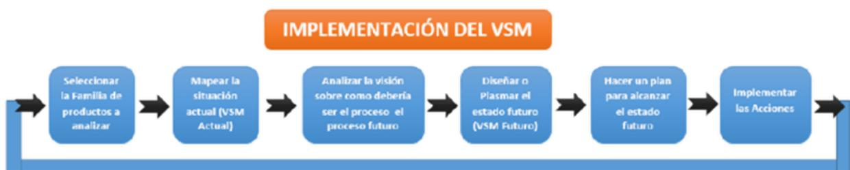
*Nota:* Herramienta que sirve para entender y ver el proceso identificando los desperdicios que se muestran. Fuente: <http://www.leansolutions.co/conceptos/vsm/>
