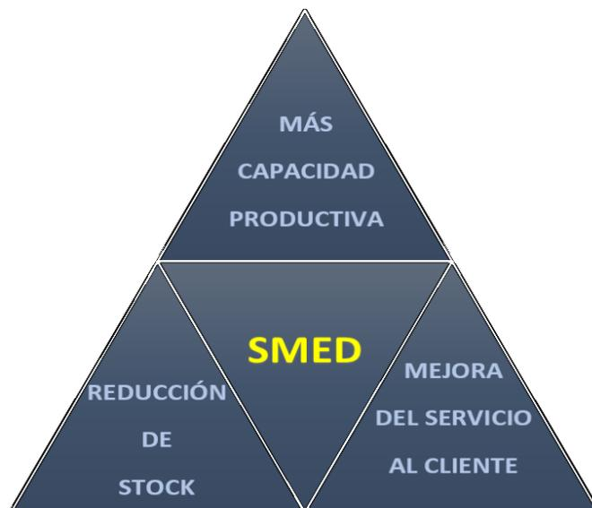
*Nota:* Herramienta que permite la reducción de los tiempos de preparación de máquina.
