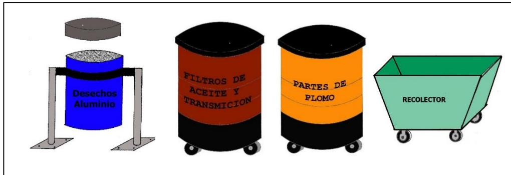
Figura 27 Recipientes para la recolección de desechos sólidos. En la imagen se muestra los diferentes depósitos de recolección de desechos sólidos.
