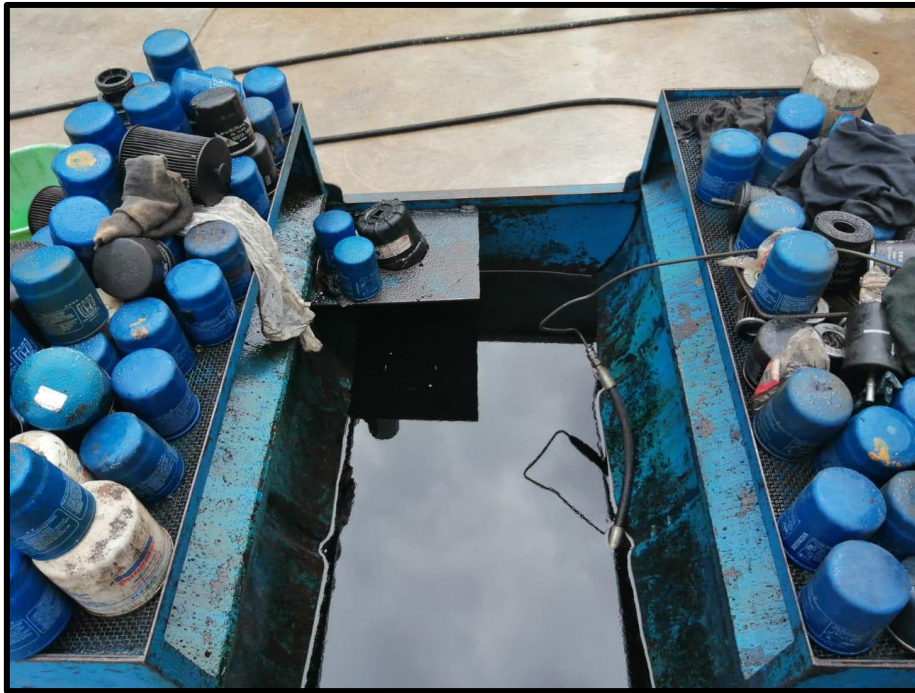
Figura 19 Desechos sólidos sin el adecuado almacenamiento.
