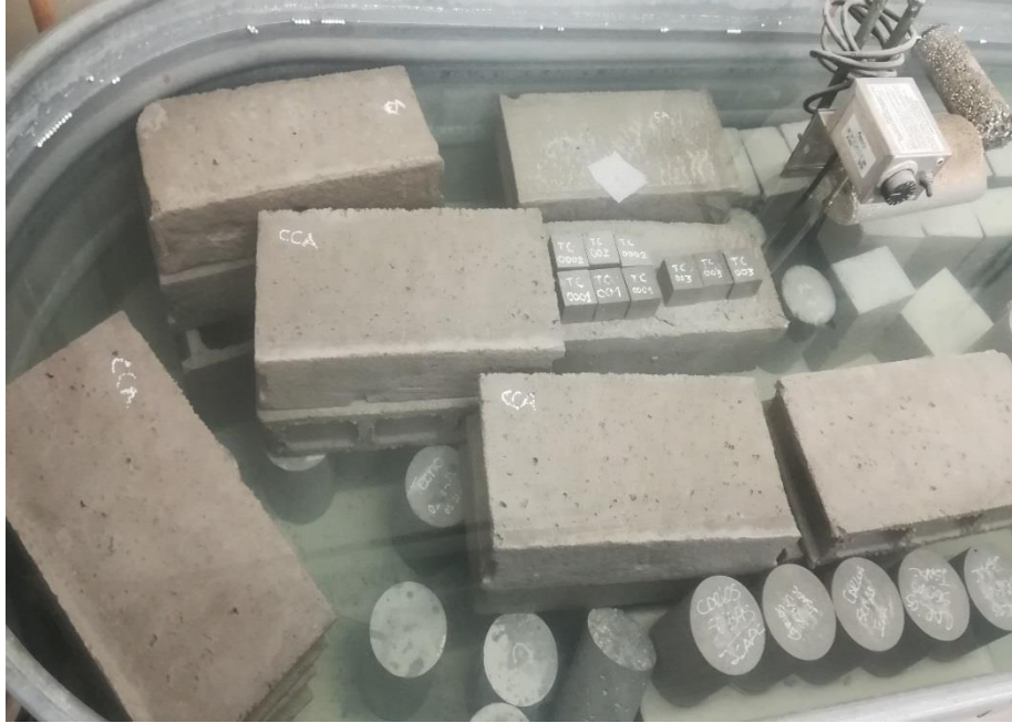
fotografía 15 Curado de las mezclas con rotulado
