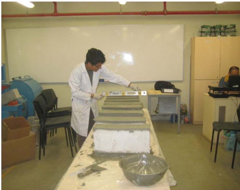
fotografía 25 Caping con yeso y cemento en los bloques de concreto
