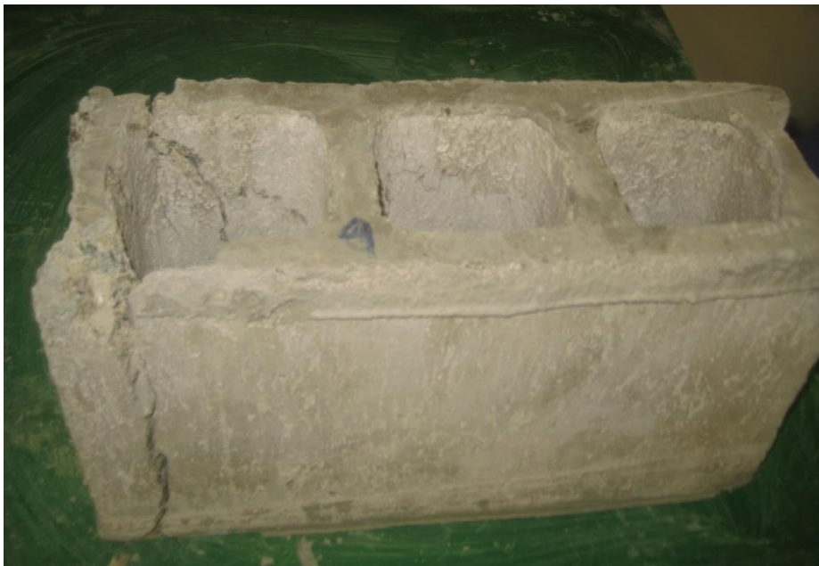
fotografía 35 Falla en tabique exterior, bloque sin adición
