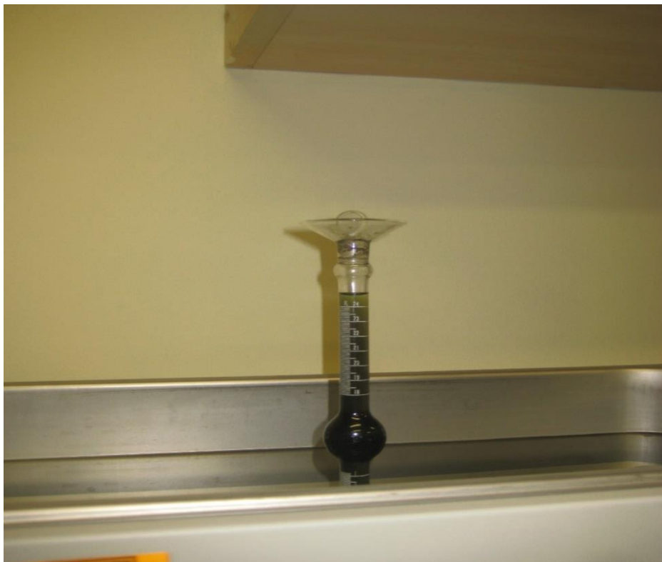
fotografía 23 Midiendo el Volumen final para el peso específico de la CCA
