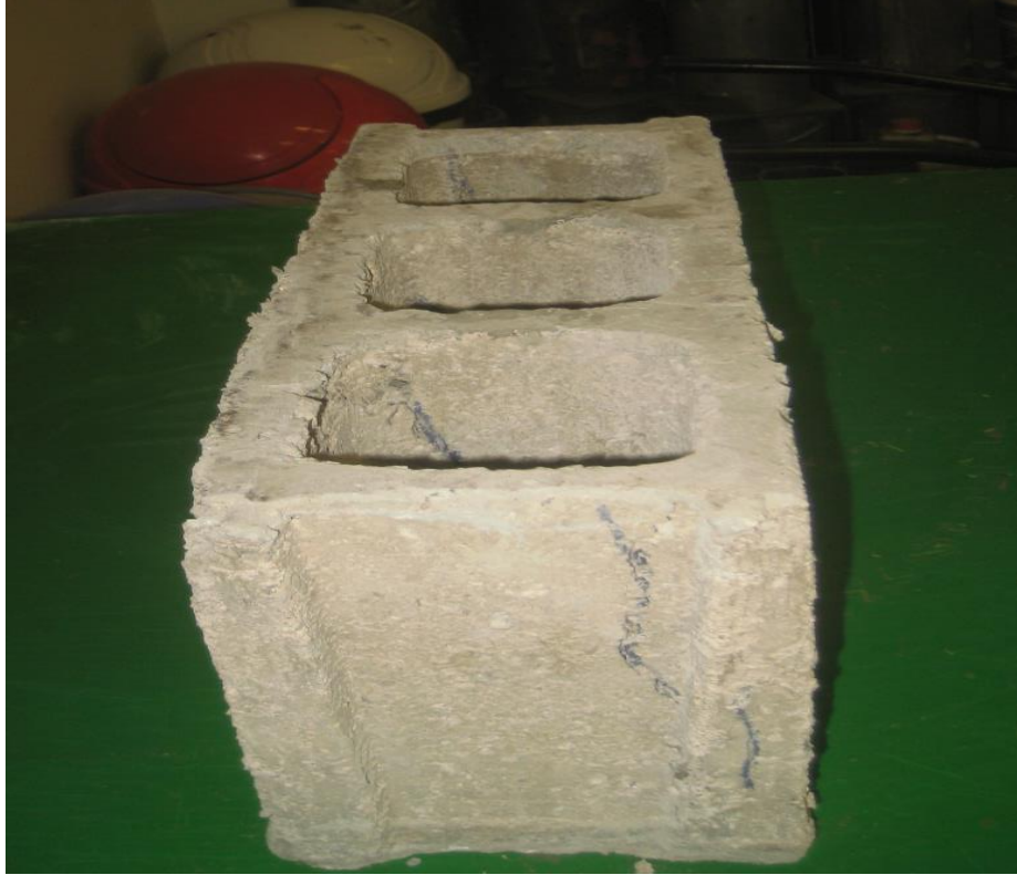
fotografía 34 Falla por cizallamiento, bloques sin adición
