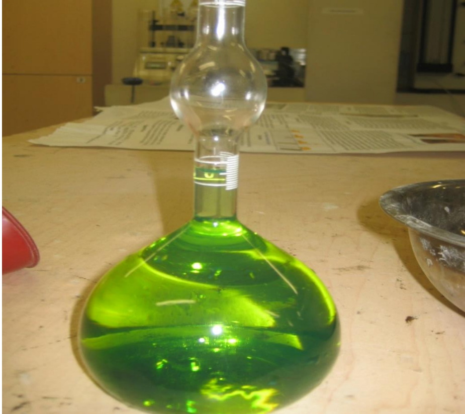
fotografía 21 Diesel como liquido para peso específico
