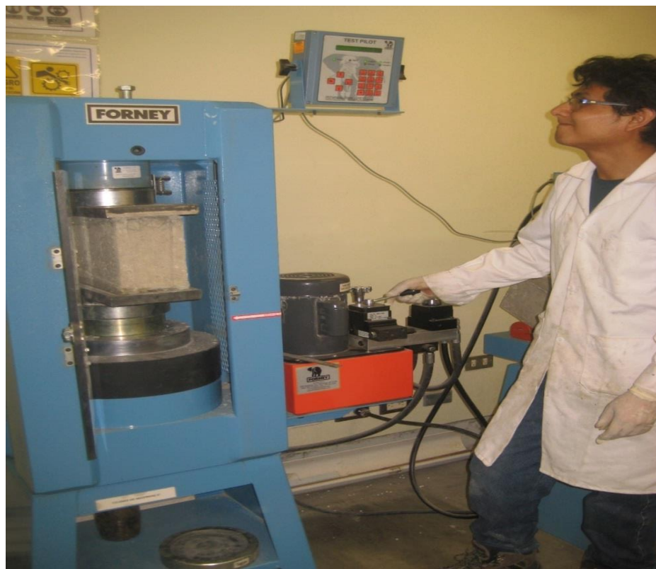
fotografía 27 Máquina de compresión marca Forney
