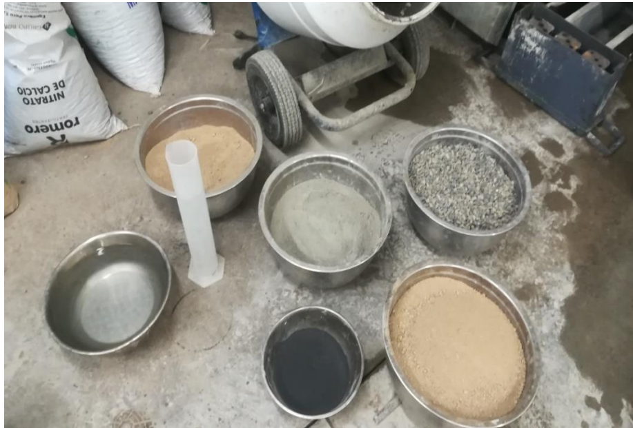
fotografía 12 Dosificación con sustitución de CCA
