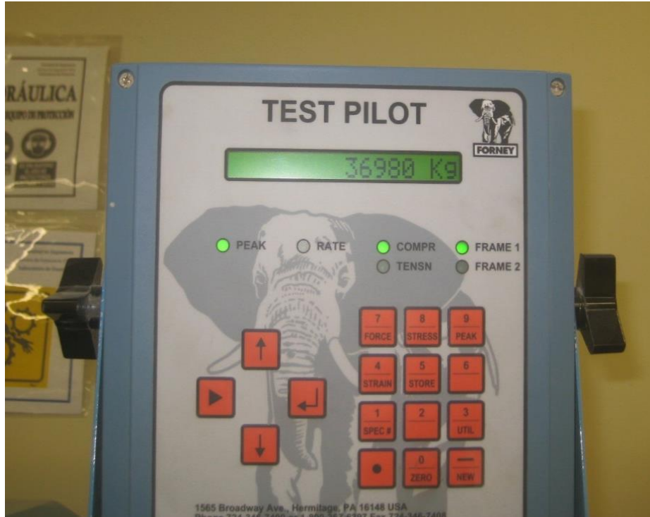
fotografía 30 Mayor carga soportada por los bloques con CA
