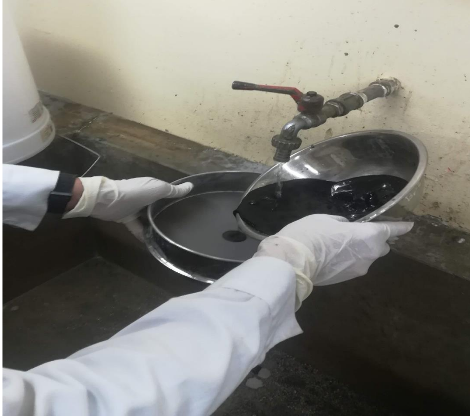
fotografía 17 Lavado por la malla #325 para la granulometría de la ceniza de cascarilla de arroz
