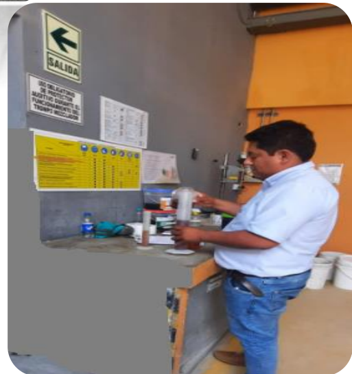
Medición de aditivos superplastificantes
