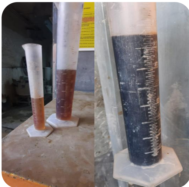
Medición de aditivos superplastificantes
