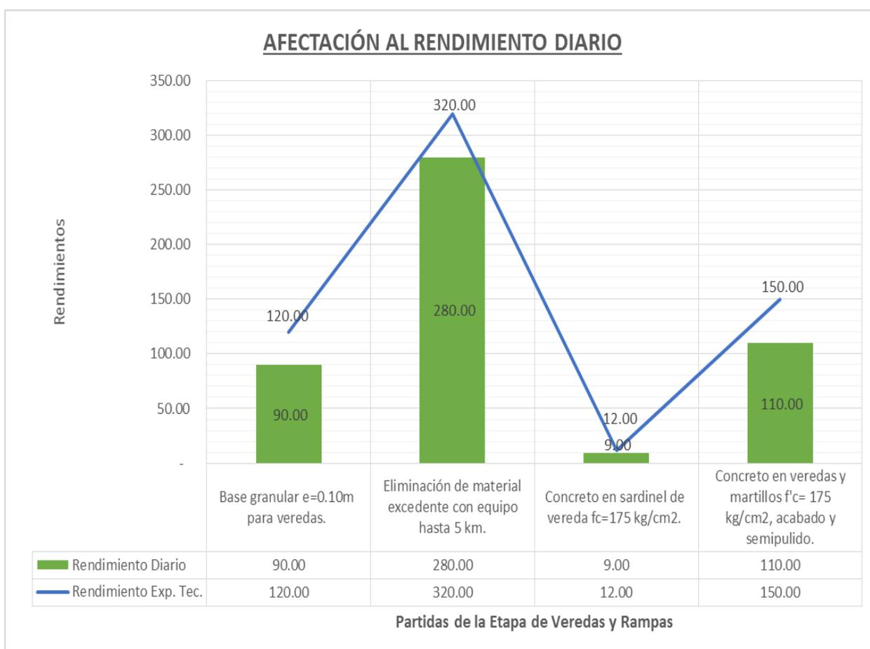
*Figura 34:* Grafica de rendimiento diario real Vs. rendimiento del Exp. Técnico – Veredas y rampas
