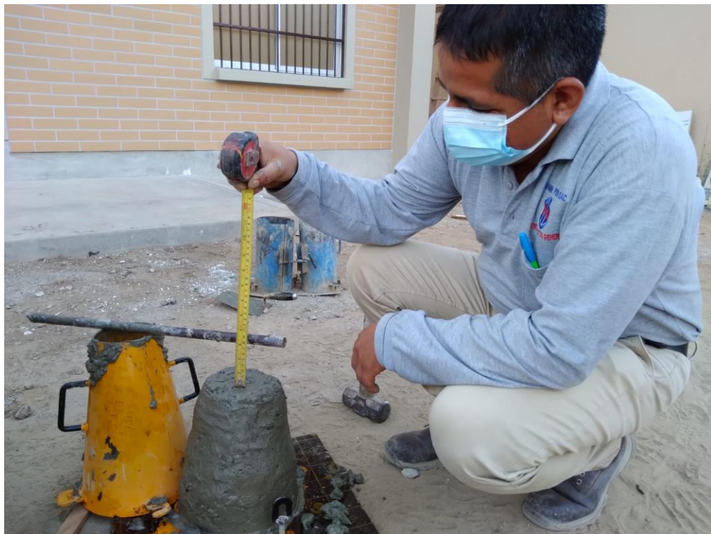
Figura 40: Ensayo de Asentamiento
