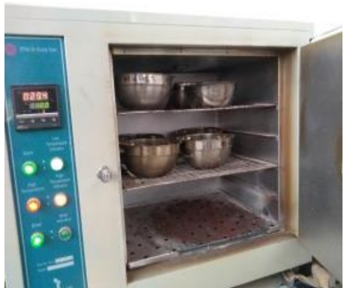
✓ Puesta de muestra en horno para contenido de humedad y retiro despues de 24 horas
