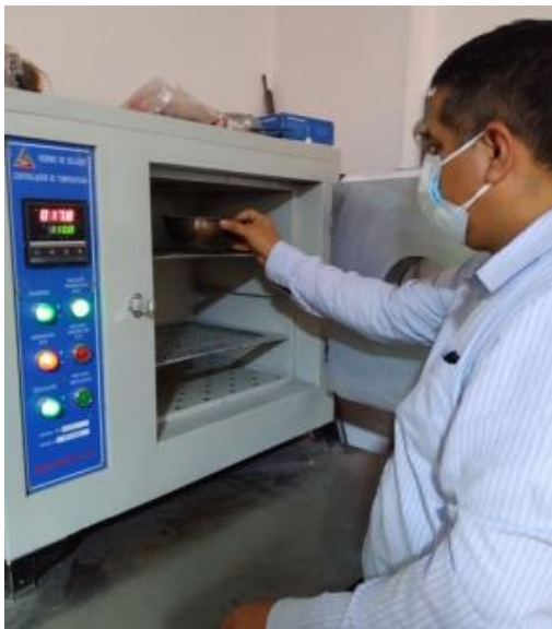
✓ Colocación de muestra en horno para determinar el contenido de humedad
