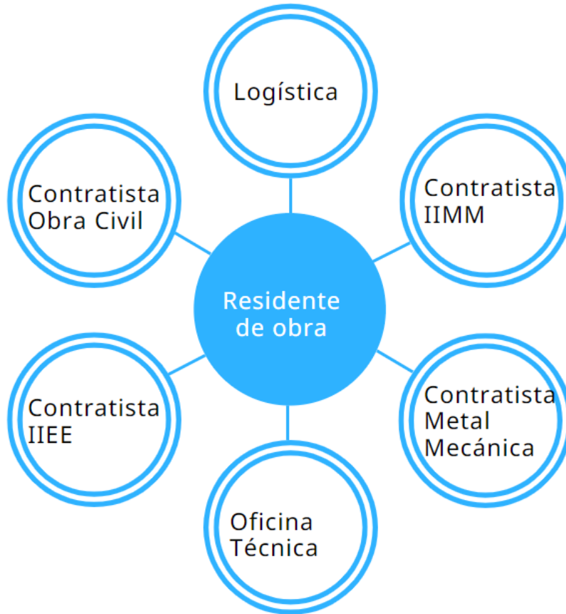
Figura 19. Representación gráfica de un sistema Push en obra.
