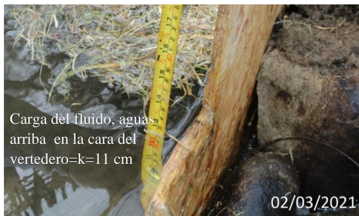
Figura 56: Carga del fluido, aguas arriba, en la cara del vertedero combinado 90° de material de madera. Fuente: Elaboración propia.
