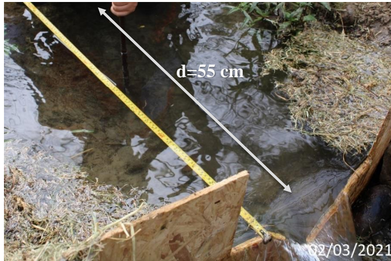
Figura 57: Distancia “d” a 5k de la cara del vertedero combinado 90^\circ de material de madera. Fuente: Elaboración propia.
