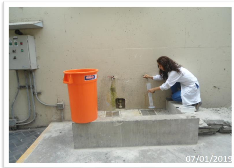
Figura 25: Calibración de volúmenes en el contenedor de almacenamiento de agua de 75 L con una probeta graduada.
