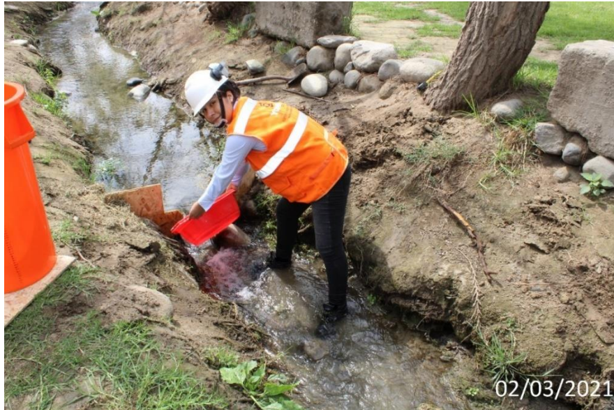
Figura 55: Método volumétrico en el vertedero combinado 90° de material de madera. Fuente: Elaboración propia.
