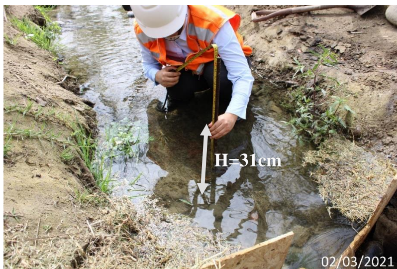
Figura 58: Carga total del vertedero combinado 90^\circ de material de madera. Fuente: Elaboración propia.
