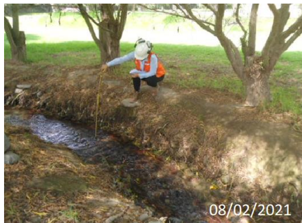
Figura 53: Medición de las dimensiones del canal de riego en el Entorno rural del sector Quives, km. 40, Lima – Canta, año 2021.
