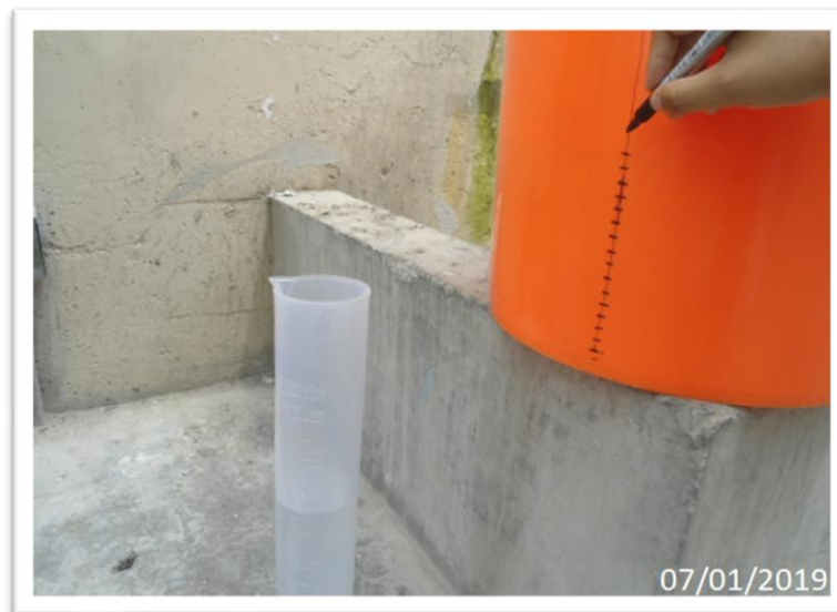
Figura 26: Calibración de volúmenes en el contenedor de almacenamiento de agua de 75L con una probeta graduada (toma cerca).
