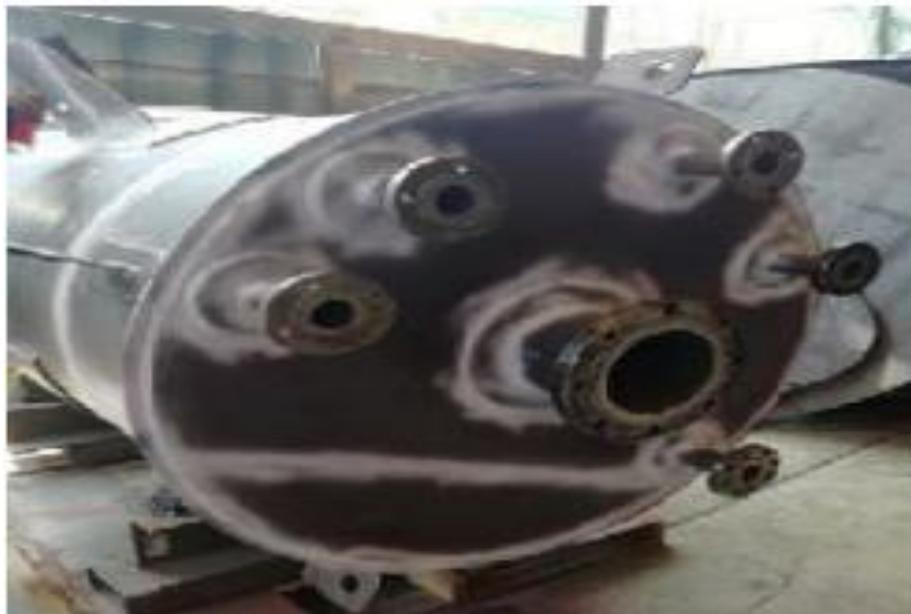
*Figura 02:* Prueba de tintes en tanque de almacenamiento.
