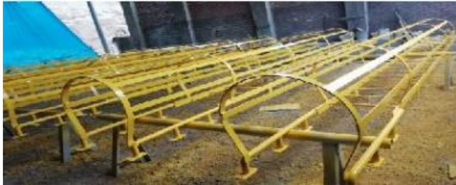
Figura 11: Accesos en proceso de secado de pintura.
