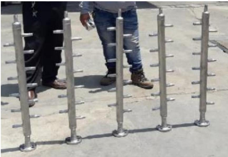
Figura 04: Manifold de aire.
