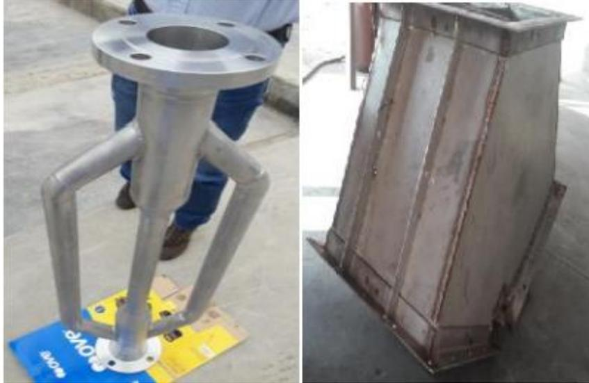
Figura 03: A la izquierda el Cortafuego y a la derecha la Válvula Diverter.
