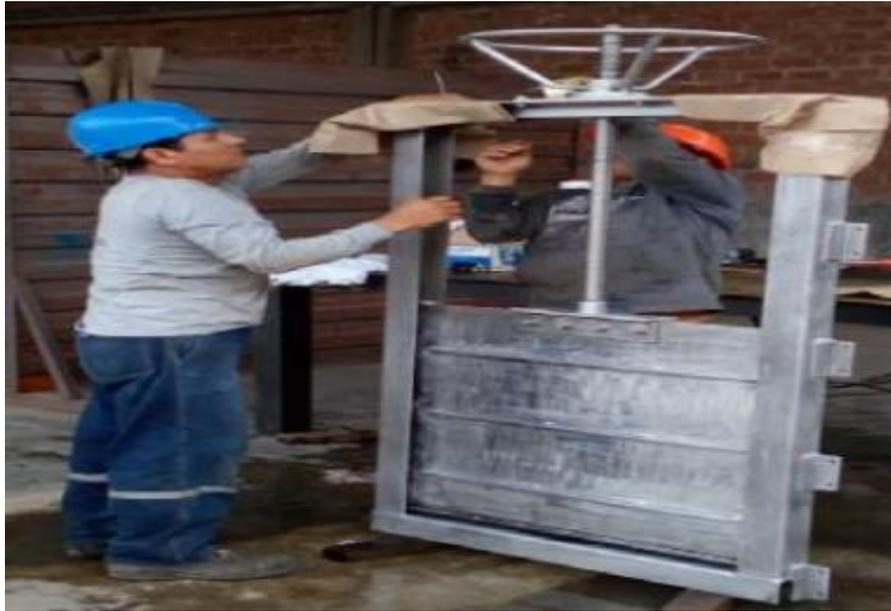
Figura 05: Compuerta metálica.
