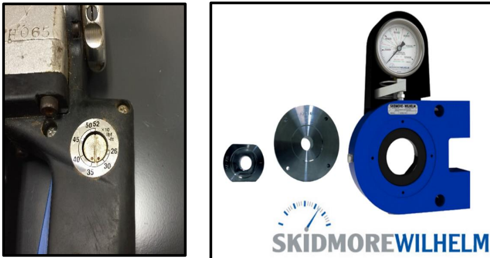
FIGURA 42: Nonio de Torquimetro y Equipo de Calibración
