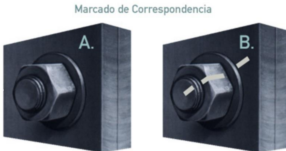
FIGURA 39: Diagrama de Instalación por Ángulo
