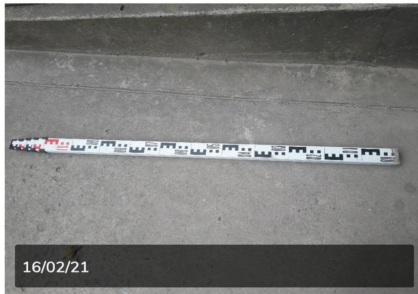
*Figura 9:* Mira topográfica de aluminio de 5 m de longitud.
