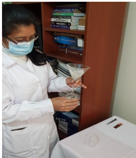
Figura 31. Secado del ánodo, cátodo y papel filtro obtenidos después de la electrodeposición. Luego se procede a tomar el peso de los mismos. Fuente: Propia (2020).
