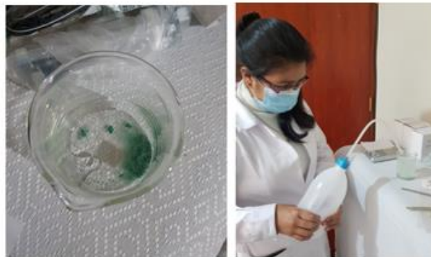
Figura 39. Aplicación de solvente ( H_2SO_4 ) a la muestra de malaquita. Fuente: Propia.
