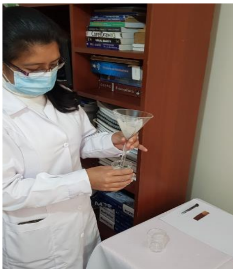
Figura 36. Secado del ánodo, cátodo y papel filtro obtenidos después de la electrodeposición. Luego se procede a tomar el peso de los mismos. Fuente: Propia (2020).
