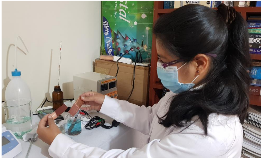
Figura 52. Cátodos con contenido de cobre después del análisis mediante la Electrodeposición.
