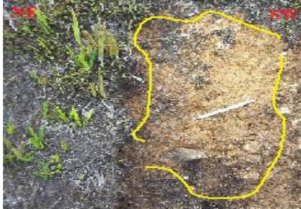
Figura 14. Depósito coluvial compuesto por fragmentos gruesos y angulares el cual está asociado a masas inestables. Fuente: Propia (2020).
