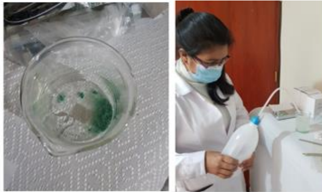
Figura 34. Aplicación de solvente ( H_2SO_4 ) a la muestra de malaquita. Fuente: Propia.
