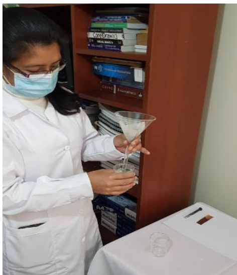
Figura 41. Secado del ánodo, cátodo y papel filtro obtenidos después de la electrodeposición. Luego se procede a tomar el peso de los mismos. Fuente: Propia (2020).
