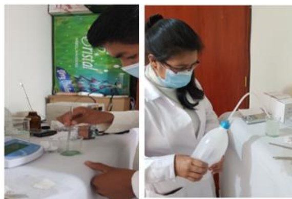
Figura 29. Aplicación de solvente ( H_2SO_4 ) a la muestra de malaquita. Fuente: Propia.
