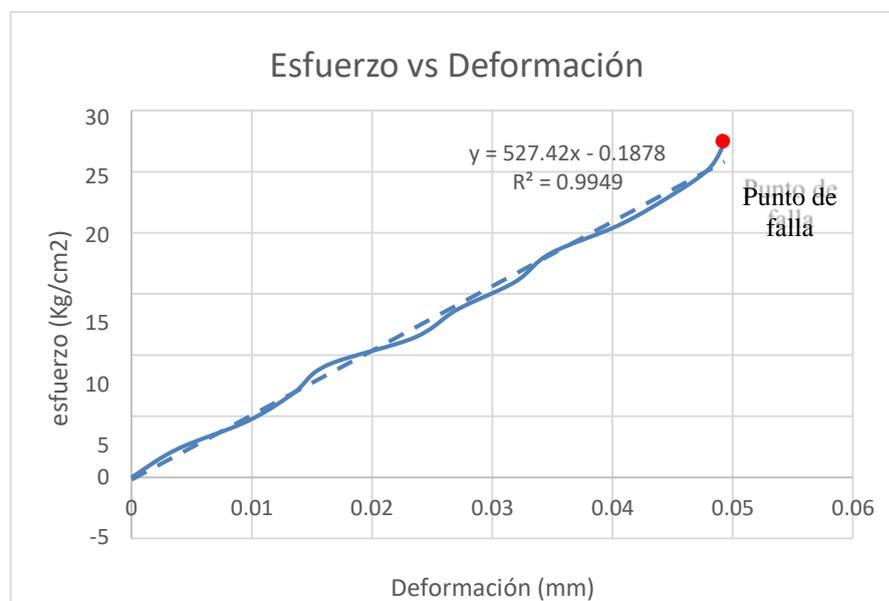
Figura 77. Curva de esfuerzo vs deformación de la muestra 08 de los bloques de adobe compactado con adición de 1.0% de aceite de linaza.
