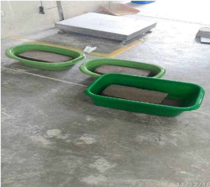
Figura 60. Adobes compactados con aditivo después de 24 horas sumergido (si resiste al agua).
