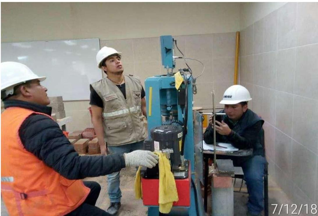
Figura 53. Ruptura de adobes en la máquina de compresión.
