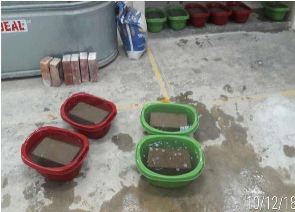
Figura 58. Adobes de cada porcentaje de aditivo, sumergidos en agua para ensayo de absorción.
