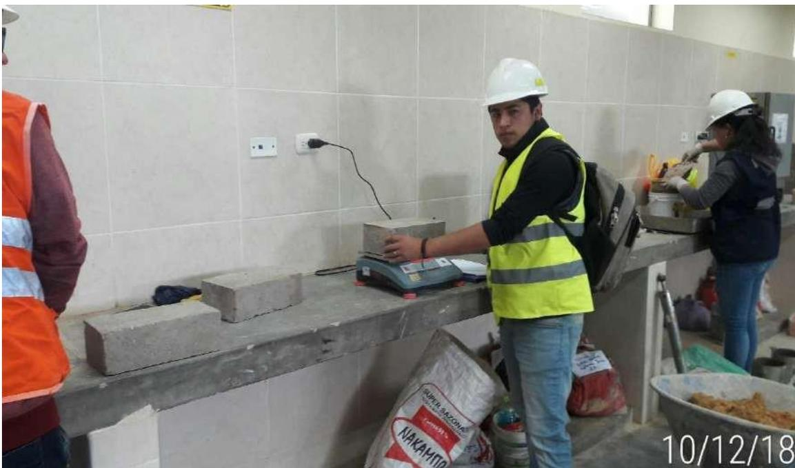
Figura 55. Pesado de muestras secas para ensayo de absorción.
