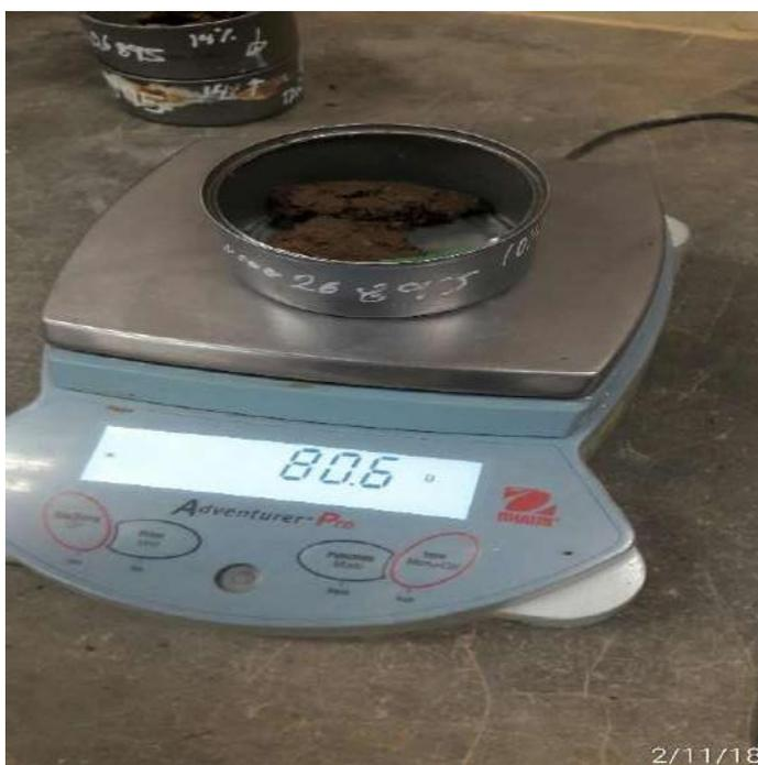
Figura 39. Peso de la muestra para determinación del contenido de humedad en el ensayo de proctor modificado.
