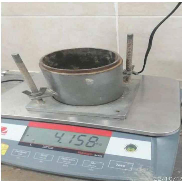
Figura 35. Peso del molde para realización de ensayo de proctor modificado.
