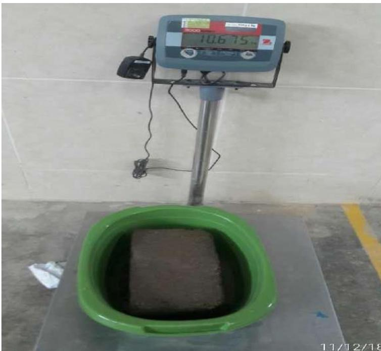
Figura 61. *Peso de* adobe compactado con adición de aditivo, después de 24 horas sumergido (si resiste al agua).
