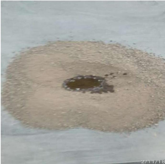
Figura 40. Muestra de suelo con aceite de linaza para realización de ensayo de proctor.
