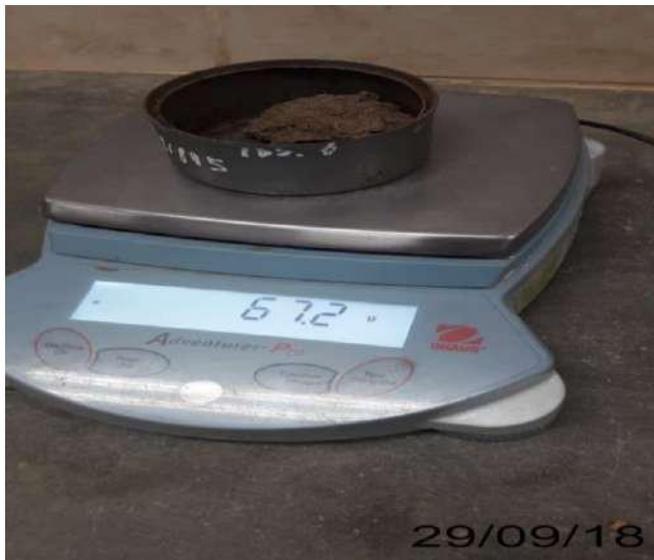
Figura 7. Peso de la muestra para contenido de humedad.
