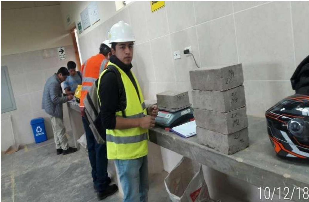
Figura 56. Obtención de pesos de las muestras secas de cada porcentaje de aditivo para ensayo de absorción.
