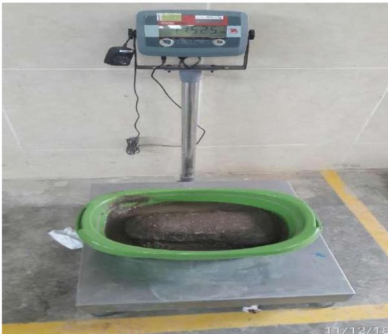
Figura 59. Adobe compactado sin aditivo, sumergido en agua durante 24 horas (no resiste al agua).
