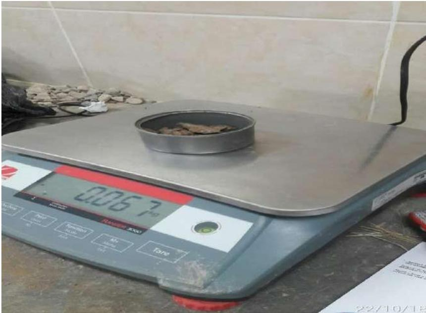
Figura 30. Peso para ensayo de contenido de humedad.
