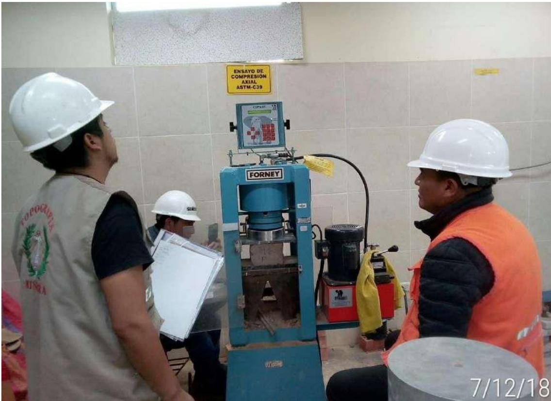
Figura 54. Toma de datos de ensayo de compresión para su posterior procesamiento
