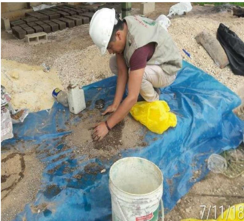
Figura 43. Realización del ensayo con aditivo (aceite de linaza).
