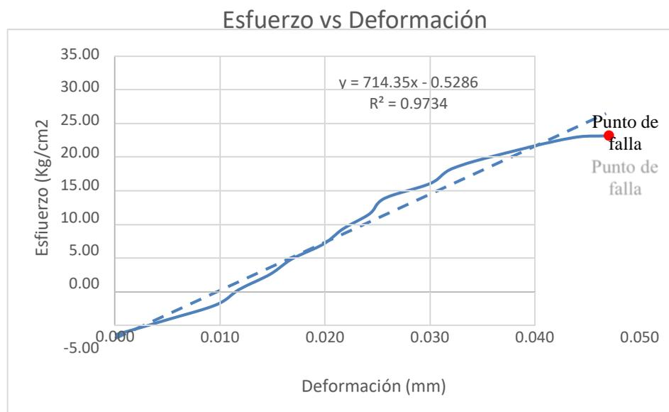
Figura 85. Curva de esfuerzo vs deformación de la muestra 08 de los bloques de adobe compactado con adición de 1.5% de aceite de linaza.
