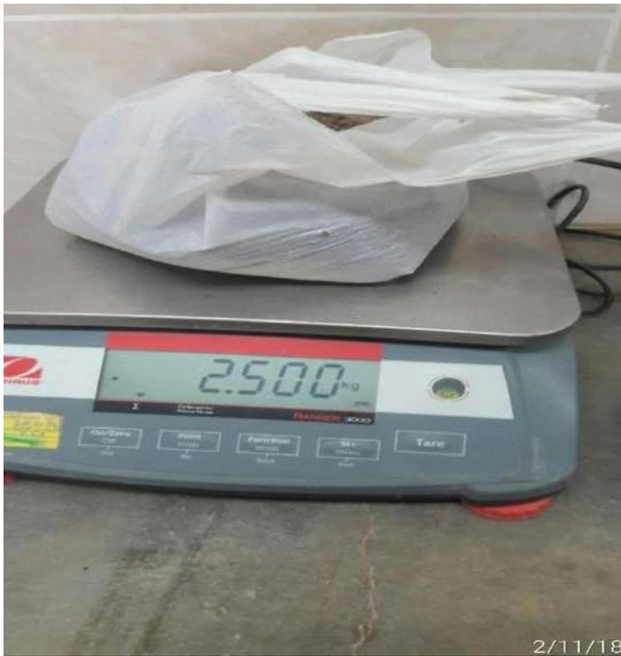
Figura 36. Peso de la muestra para el ensayo de proctor modificado.
