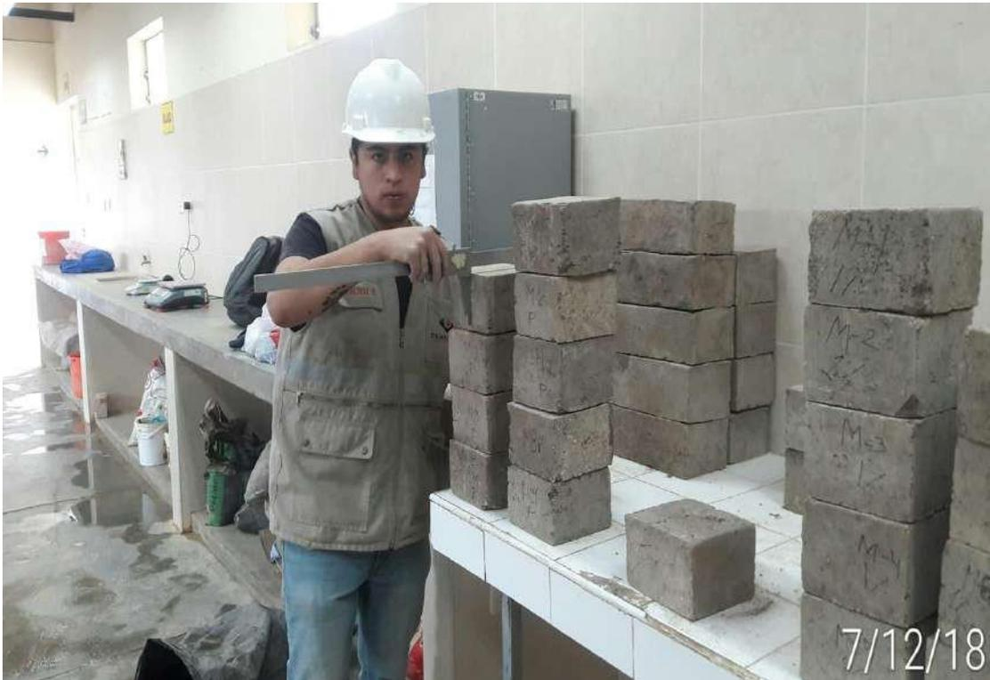
Figura 52. Medición de los adobes compactados con aditivo para ensayo de compresión.
