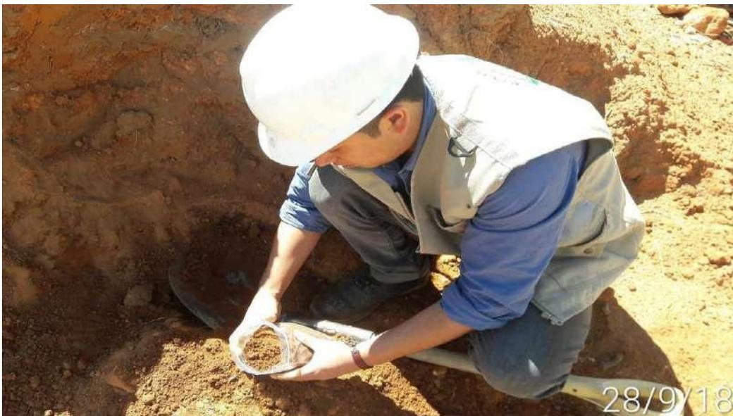
*Figura 29.* Extracción del material para realizar ensayos de laboratorio.
