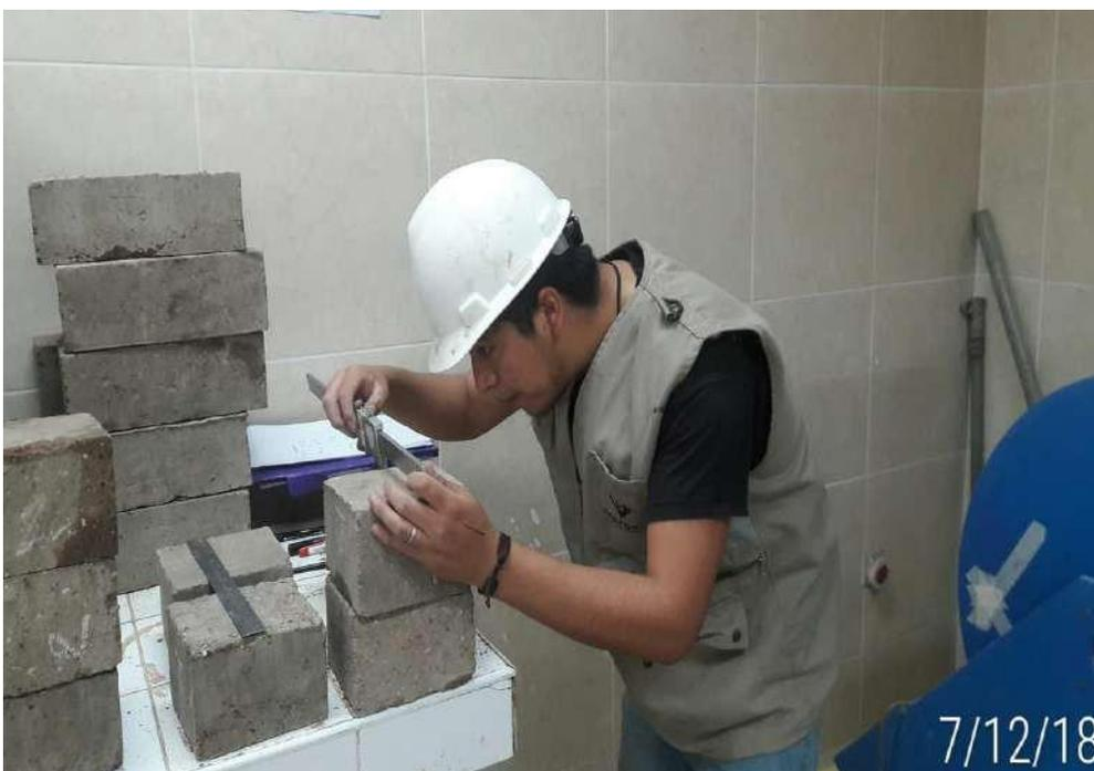
*Figura 51.* Medición de los adobes compactados patron para ensayo de compresión.
