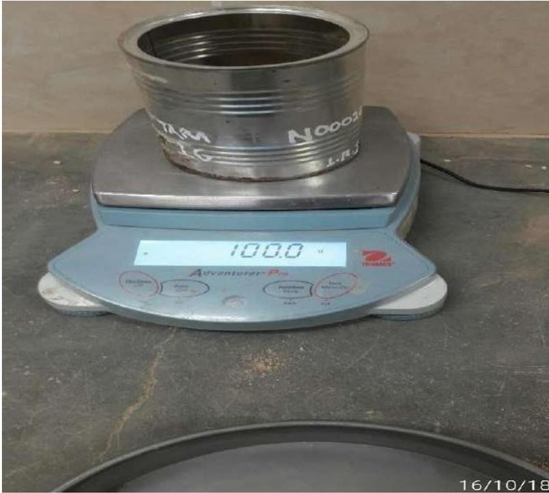
Figura 32. Peso del material utilizado para el ensayo de sifonaje.
