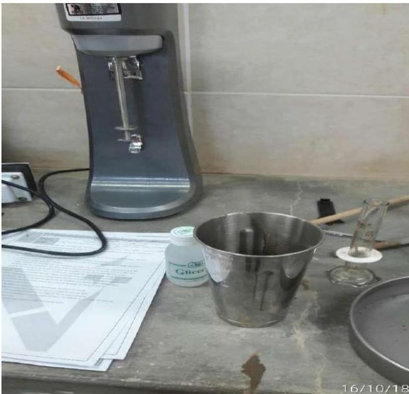
Figura 33. Colocación de muestra en agitador mecánico.
