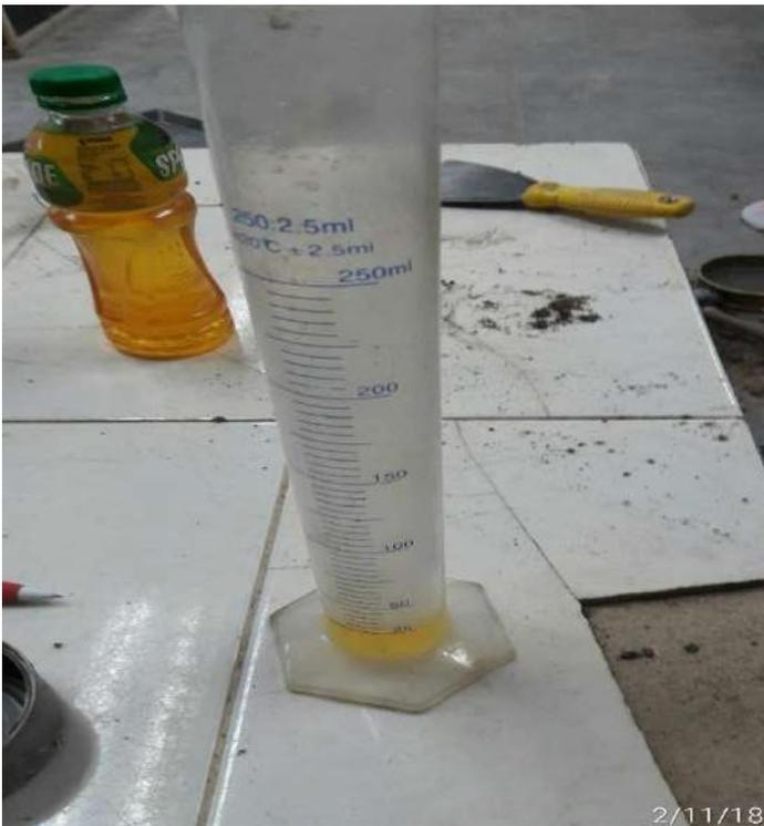
Figura 41. Dosificación de aceite de linaza para realizar el ensayo de proctor modificado.
