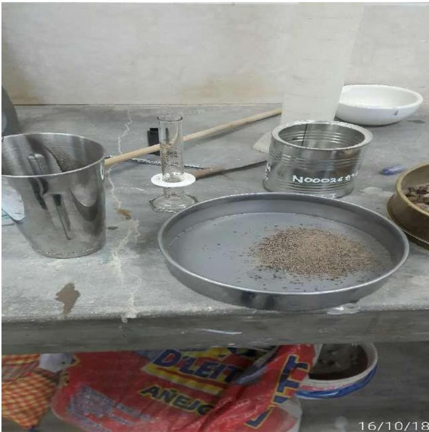
Figura 31. Material para ensayo de sifonaje.
