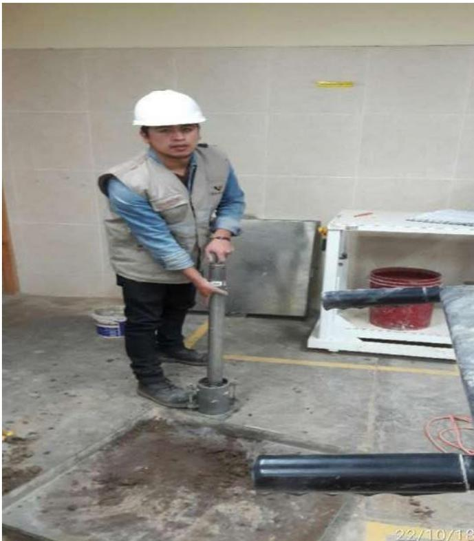
Figura 37. Realización del ensayo proctor modificado sin aditivo (aceite de linaza).
