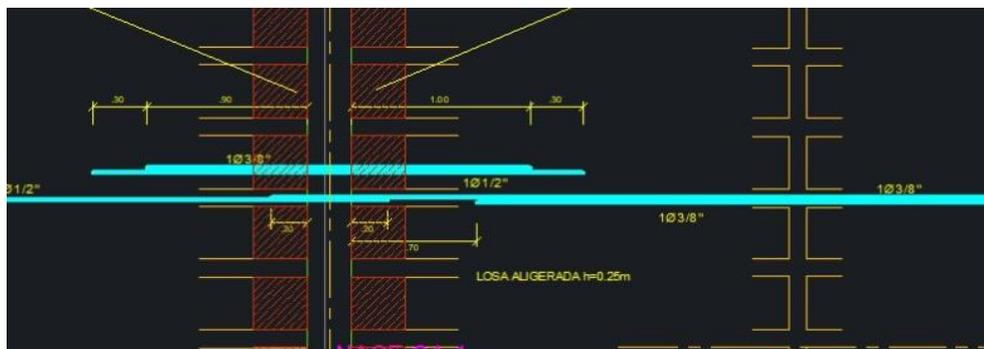
Figura 28. Acero Negativo entre eje 3 - 4.
