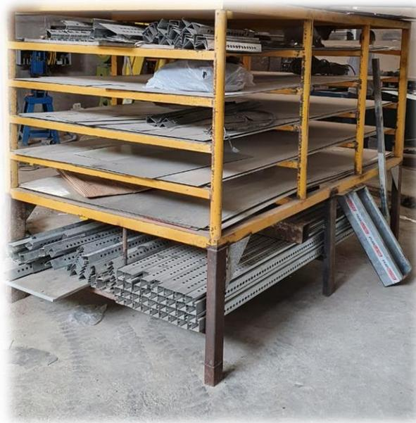
*Figura 3.5.* Estante para guardar las planchas de metal
