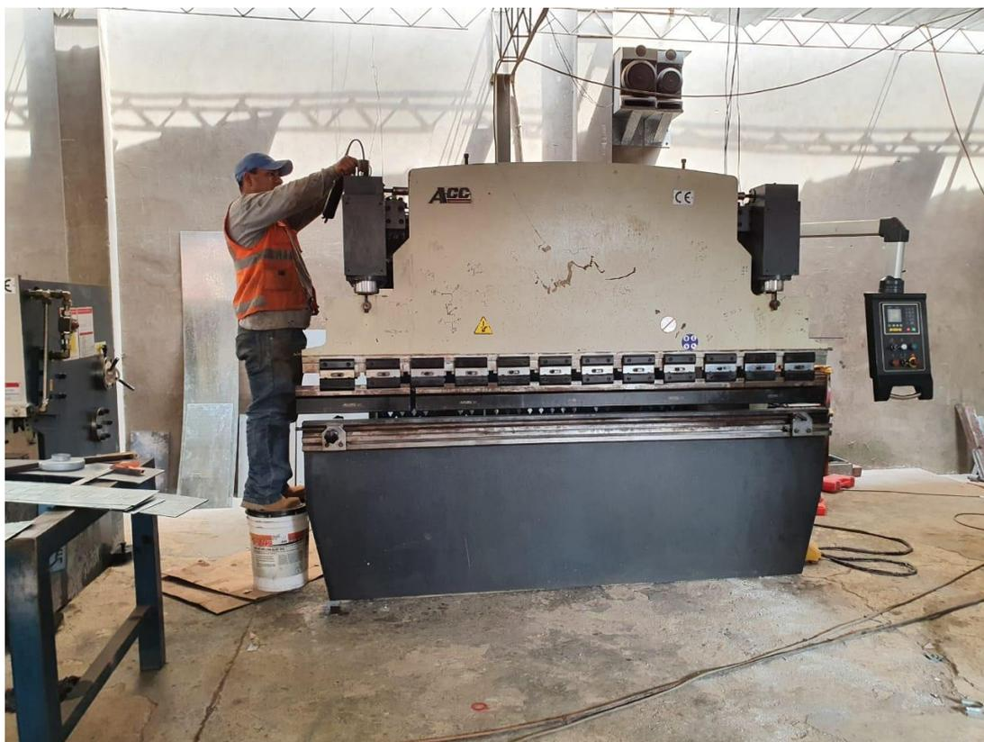
*Figura 2.8.* Vista frontal de la máquina dobladora de metal
