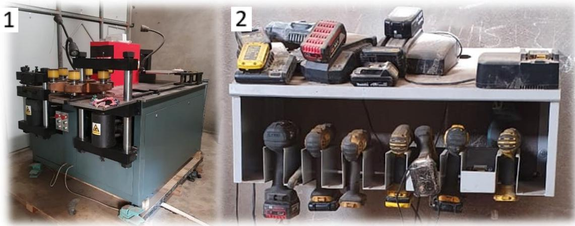
*Figura 3.1.* 1. máquina dobladora de Cobre, 2. Estante de herramientas
