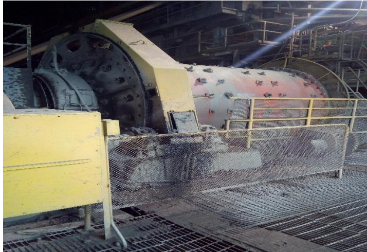
Figura 5. Molino Rodmill 3, Muestra el Molino de Barras Primario Allis Chalmers 9'x12' N° 3. Fuente: Elaboración propia.
