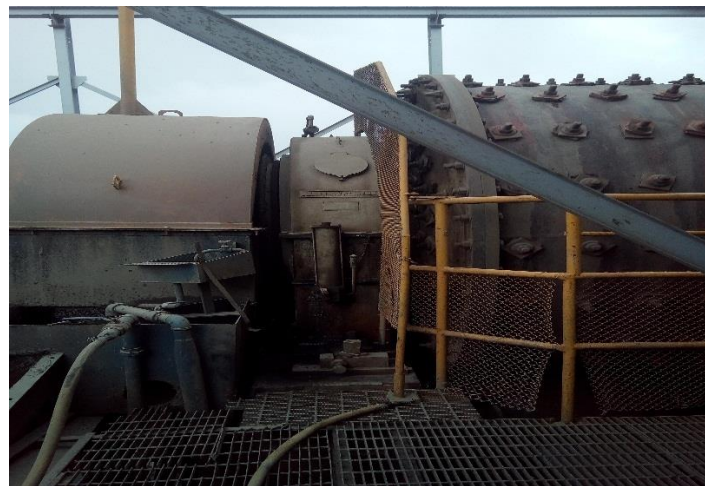
Figura 6. Molino Rodmill 4, Muestra el Molino de Barras Primario Allis Chalmers 10.5'x14' N° 4. Fuente: Elaboración propia.
