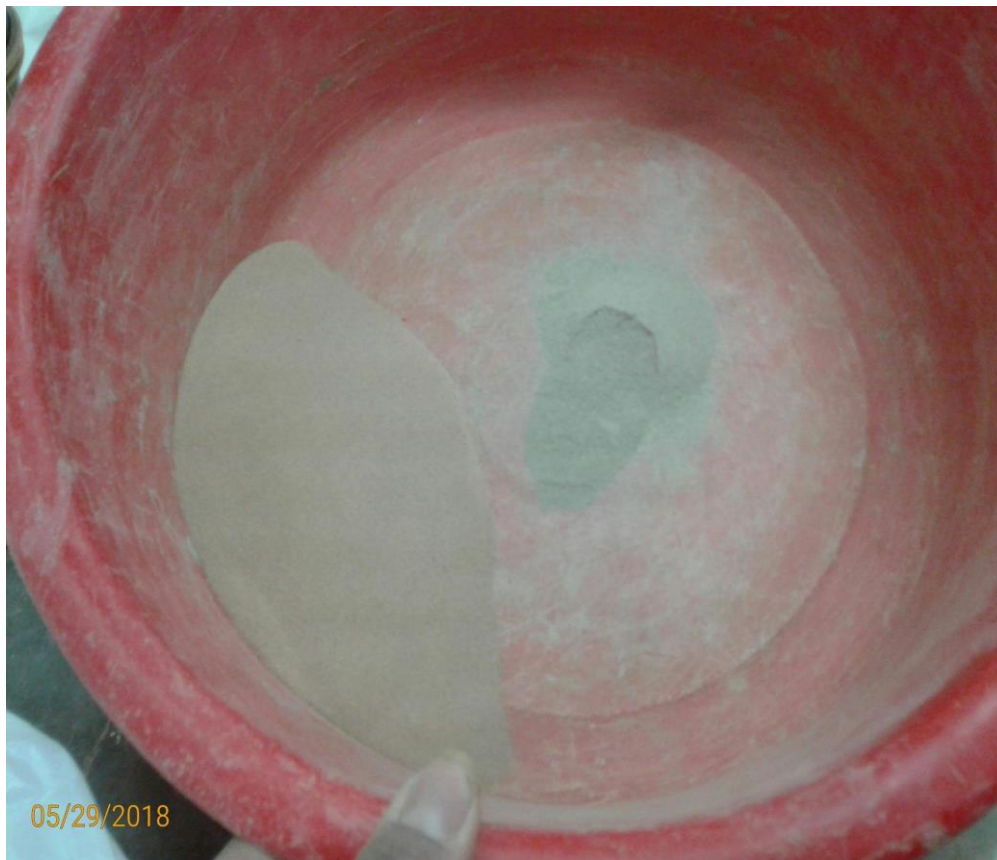
Figura 26. Adición de 4 % de RC para ensayo de límites de consistencia.
