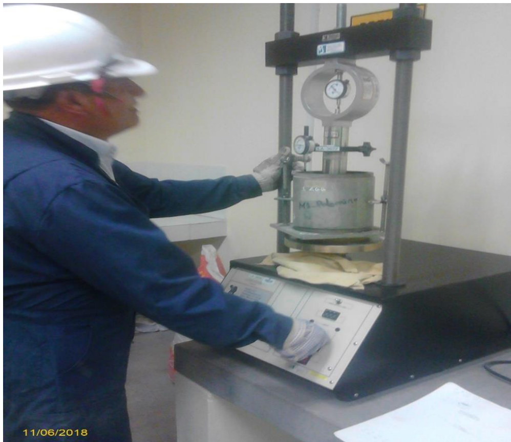
Figura 38. Ensayo de esfuerzo – penetración, prensa CBR.
