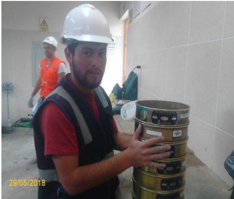
Figura 24. Tamizado para determinar la distribución granulométrica del material.
