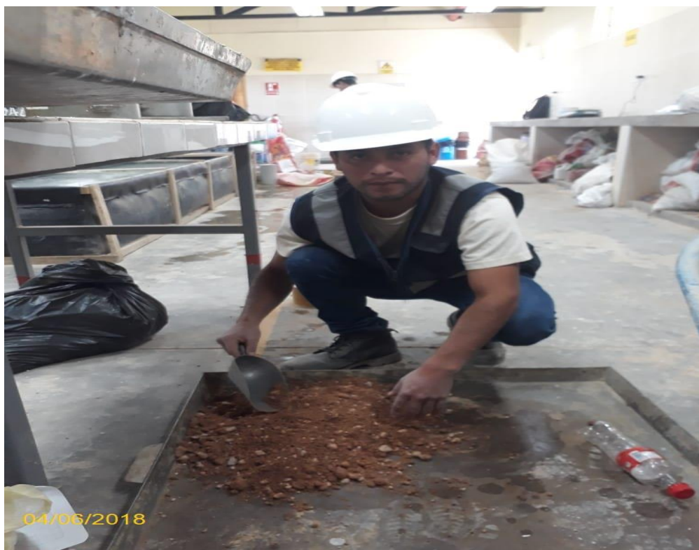
Figura 35. Preparación de muestra para ensayo de proctor modificado.
