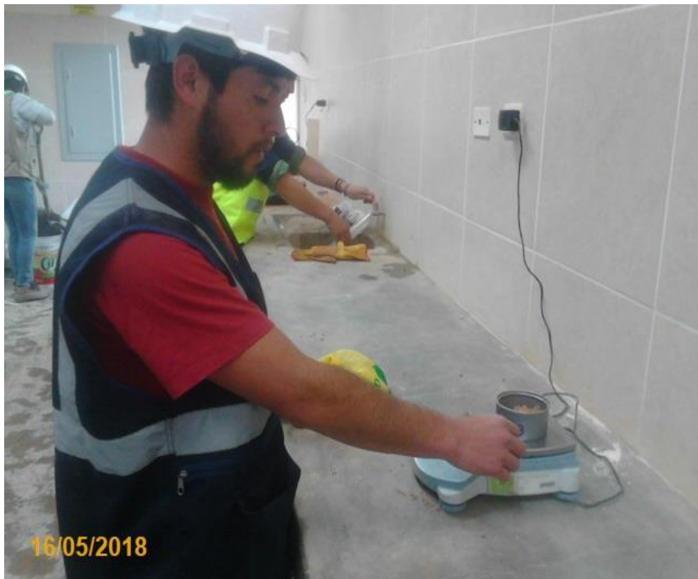
Figura 21. Pesado de muestras para determinar el contenido de humedad del material.
