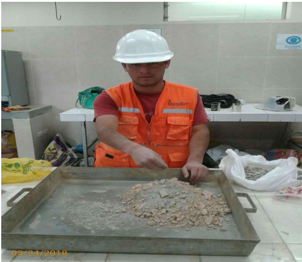
Figura 23. Mesclado de material al adicionar RC para ensayo de granulometría.
