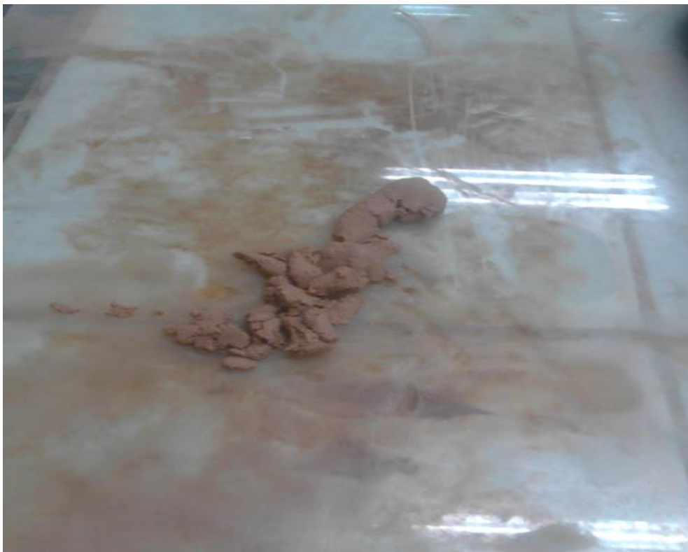
Figura 29. Ensayo de límite plástico.
