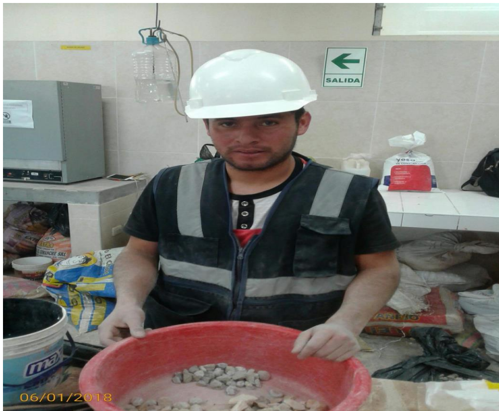
Figura 31. Proceso de adición de RC para ensayo de abrasión los ángeles.
