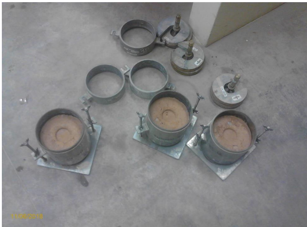
Figura 39. Especímenes después de realizado el ensayo de esfuerzo penetración.
