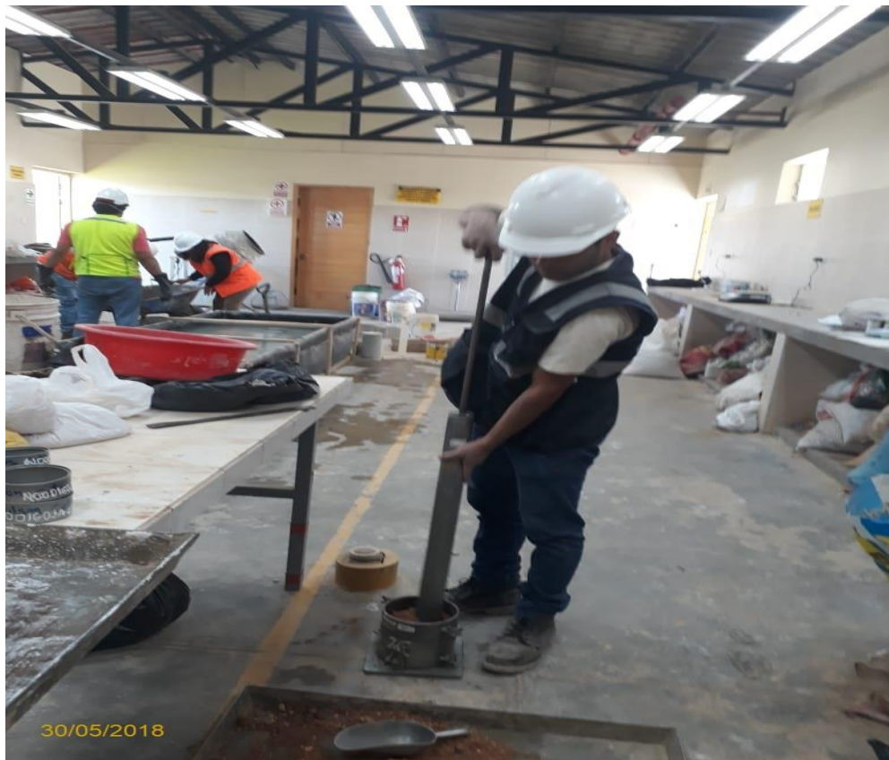
Figura 36. Compactación del material en molde tipo "C".
