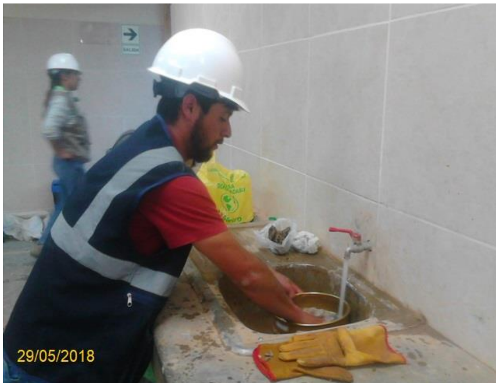
Figura 25. Lavado de material por el tamiz N° 200 para granulometría de agregado fino.
