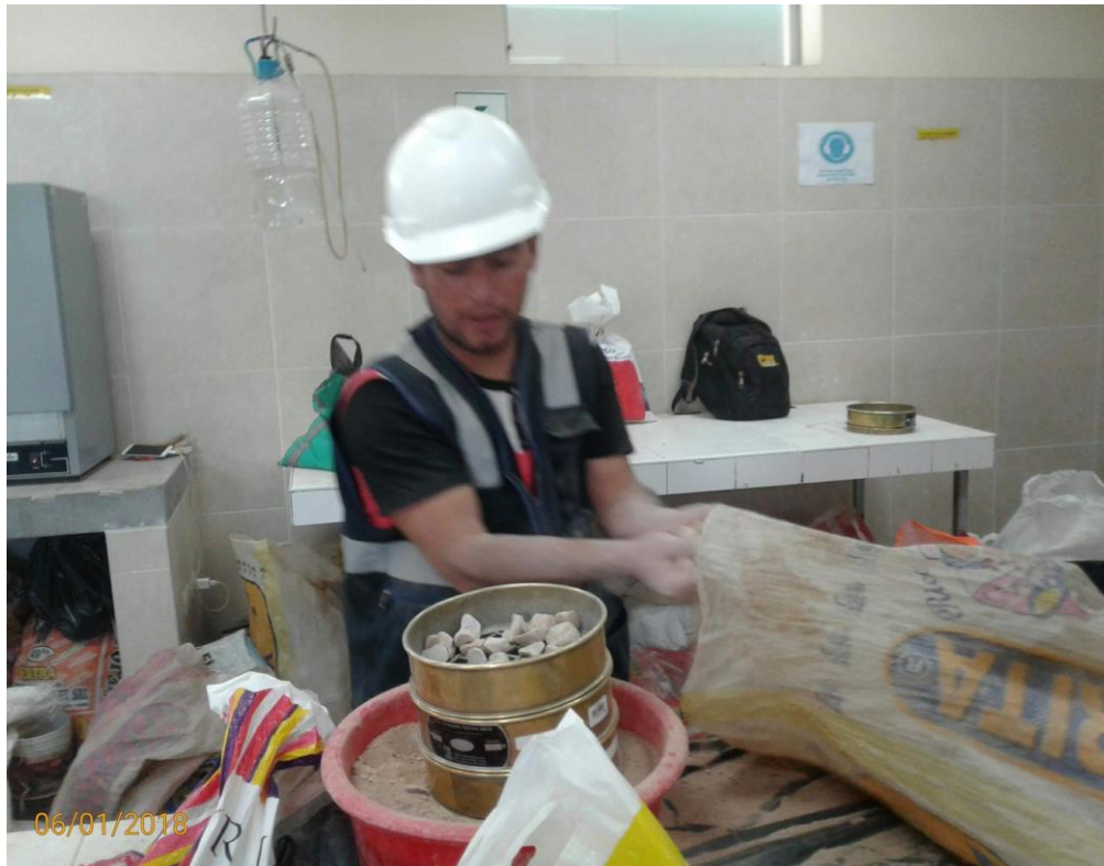
Figura 30. Granulometría del material para ensayo de abrasión los ángeles.
