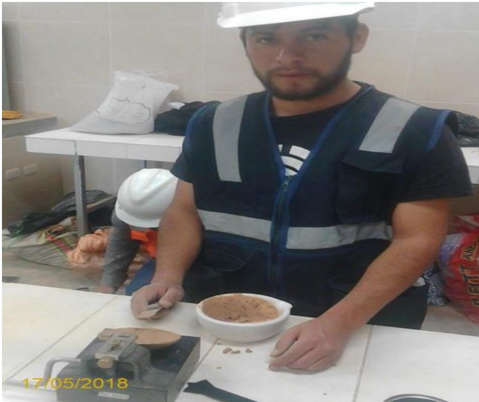
Figura 28. Ensayo de límite líquido.
