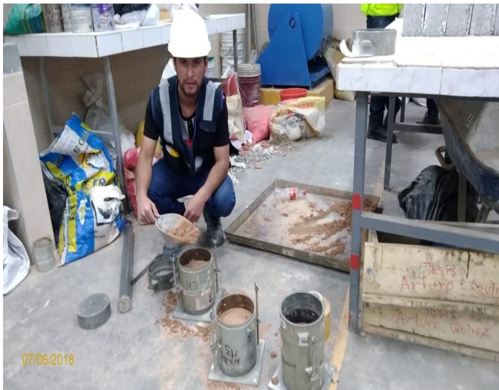
Figura 37. Compactación de muestras para ensayo CBR.
