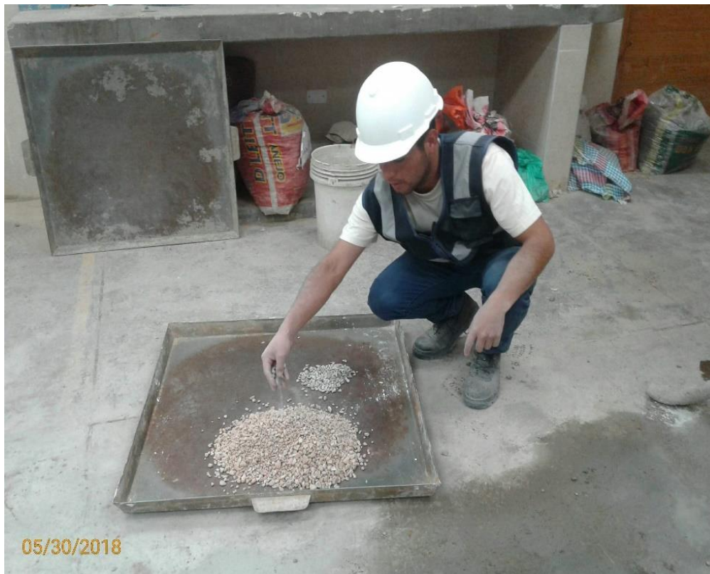
Figura 34. Proceso de adición de RC para ensayo de proctor modificado.
