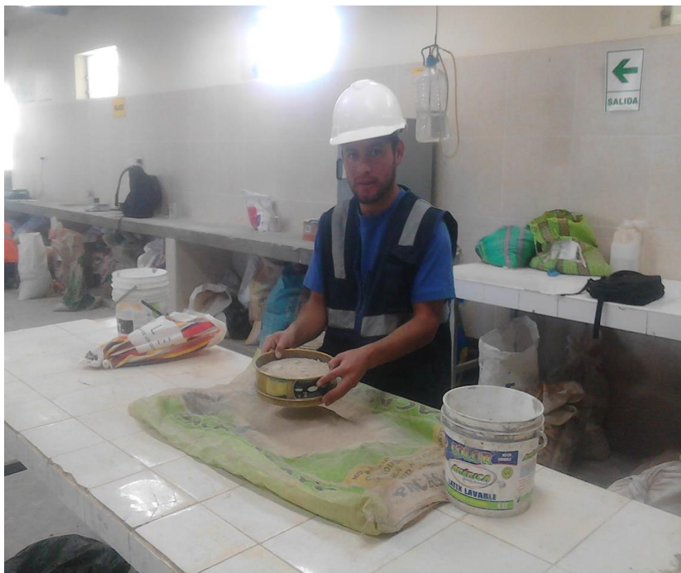
Figura 33. Tamizado del material por la malla N° 12 para determinar el % de pérdida.
