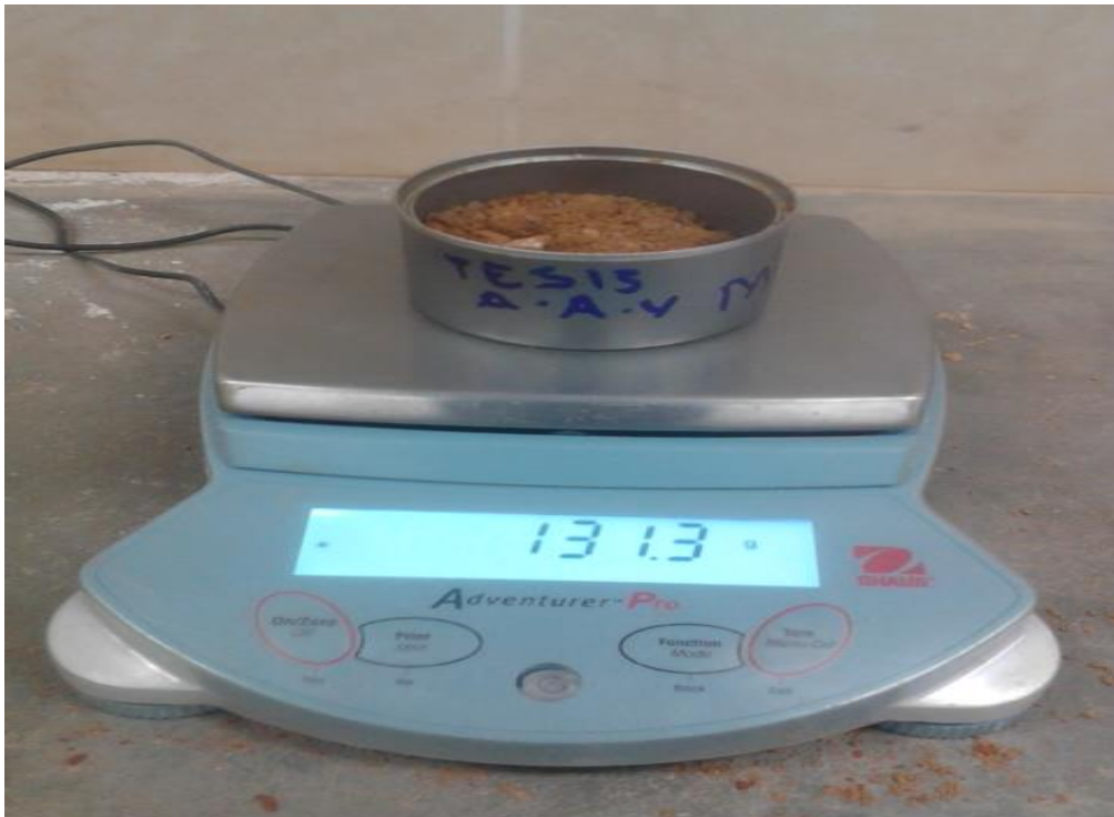
Figura 22. Ensayo de contenido de humedad – peso de muestra inalterada.
