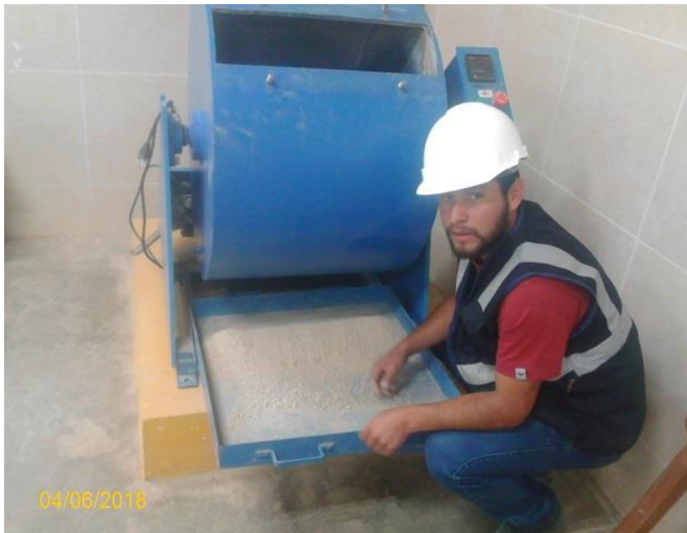
Figura 32. Muestra extraída de la máquina de los ángeles después del ensayo de abrasión.
