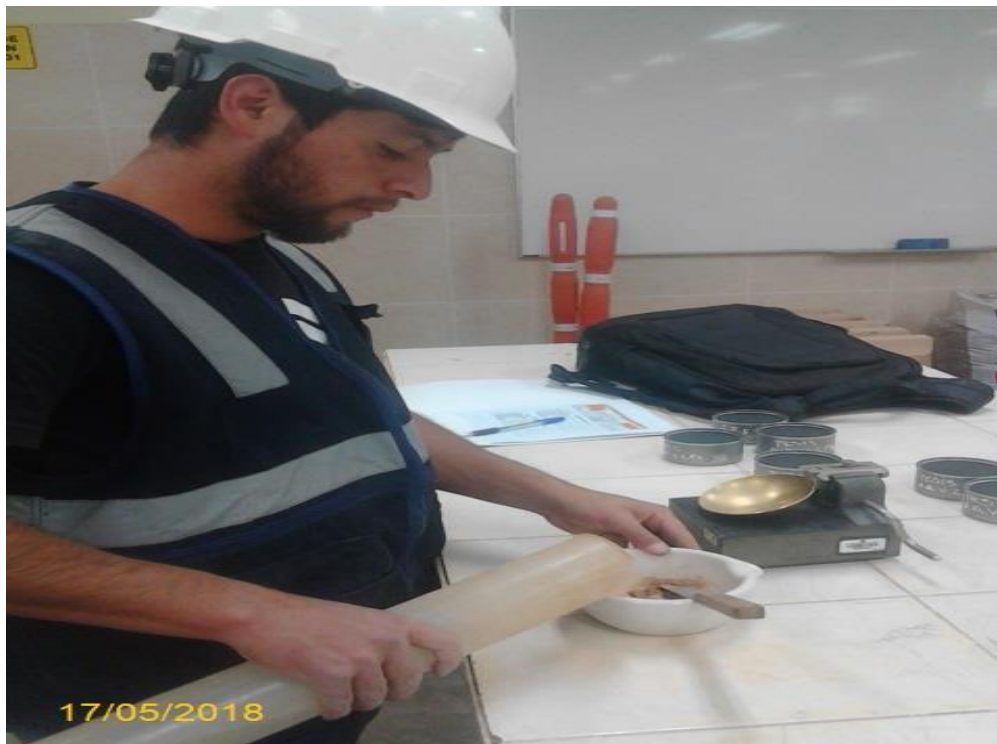
Figura 27. Preparado de muestra para ensayo de Límite líquido.
