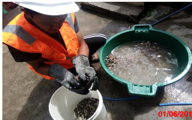
Figura 3: Lavado de base granular
