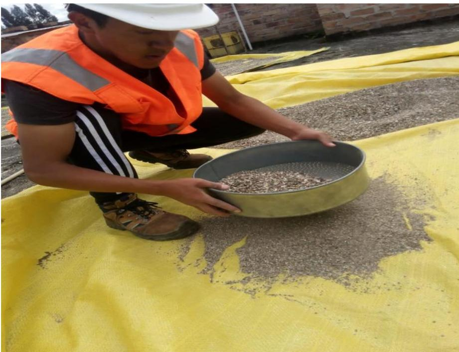
Figura 22: Tamizado de agregado fino
