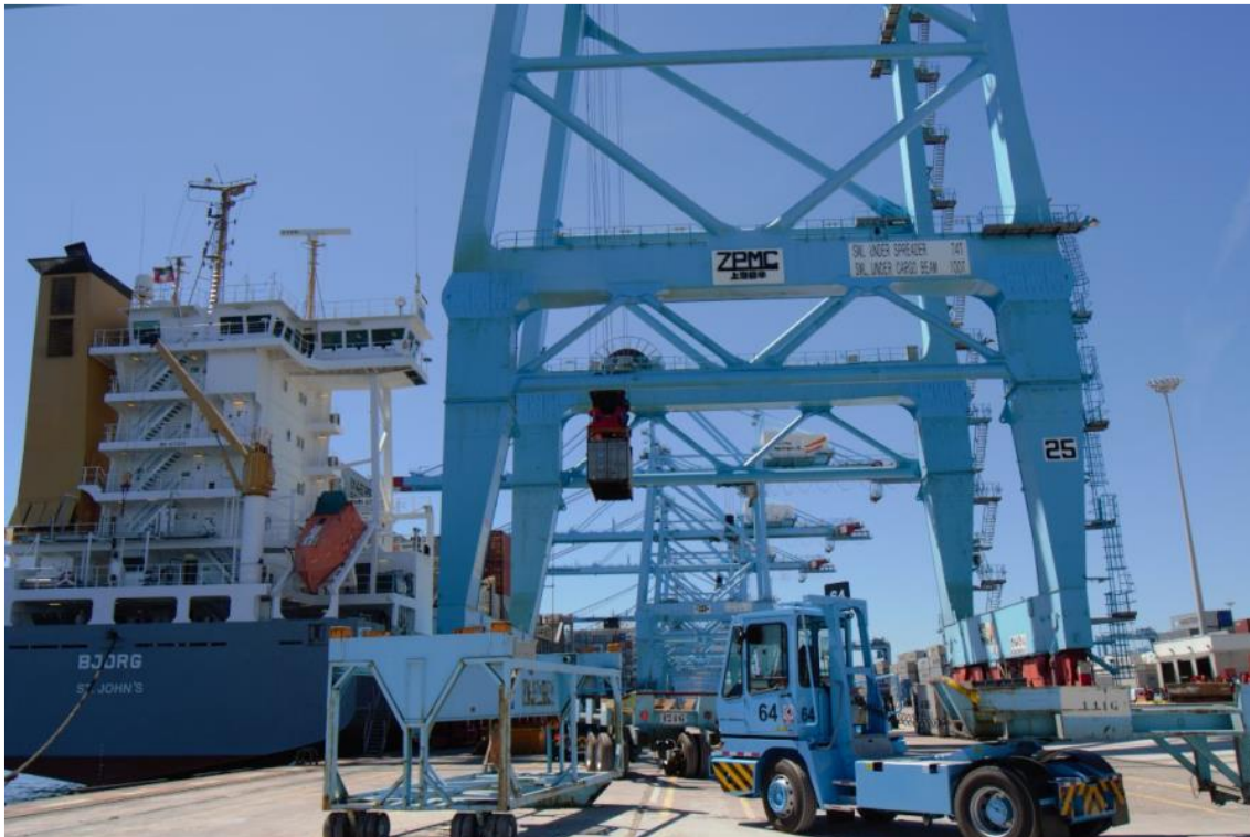
ILUSTRACIÓN 13: GRÚA PÓRTICO DE MUELLE (APM TERMINALES ALGECIRAS)
