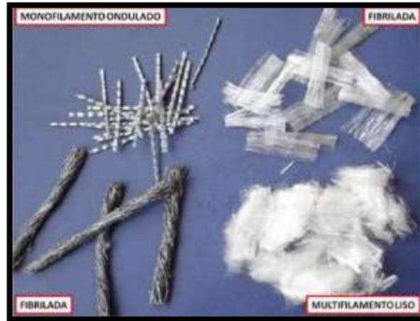
*Figura 25: Tipo de fibras de polipropileno.*
