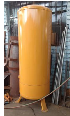
Botellón de aire con capacidad y medidas estándar (a pedido del cliente)
