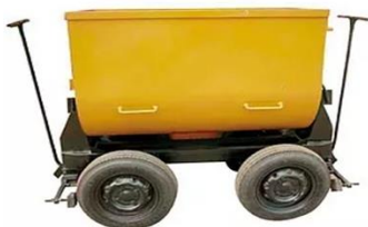
Carro minero de 850 kg hasta 1500 kg de capacidad
