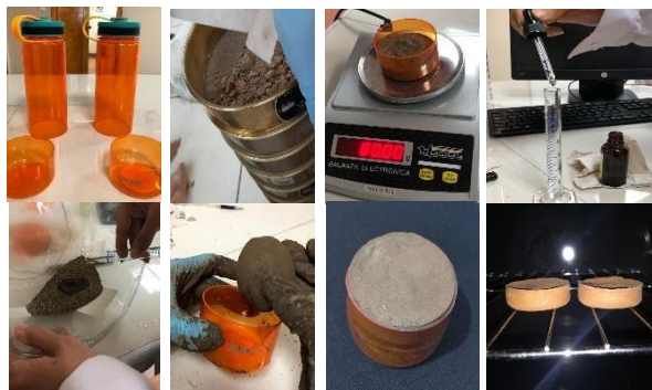
Fig. 2. Protocolo de elaboración de filtros de arcilla con plata coloidal y nanopartículas de plata.
