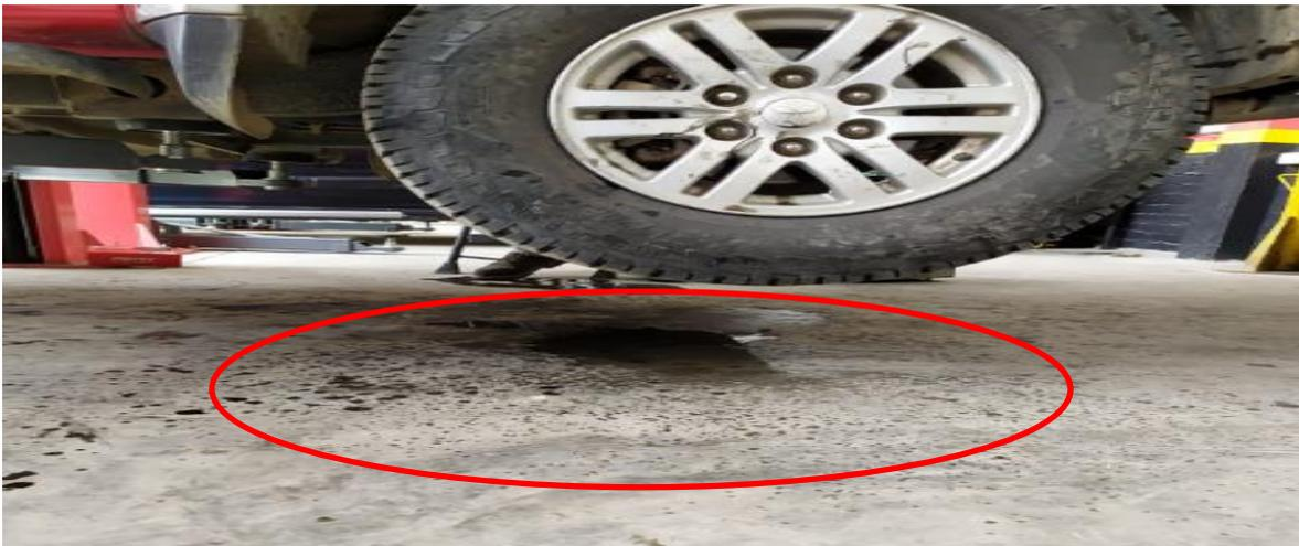
Figura 18: Al momento de pasar por el área de sistema de inyección en el cual hacen el cambio de los líquidos, se ve en la imagen el derrame de los líquidos.
