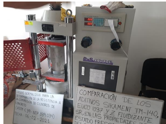
Muestra de concreto en la prensa hidráulica
