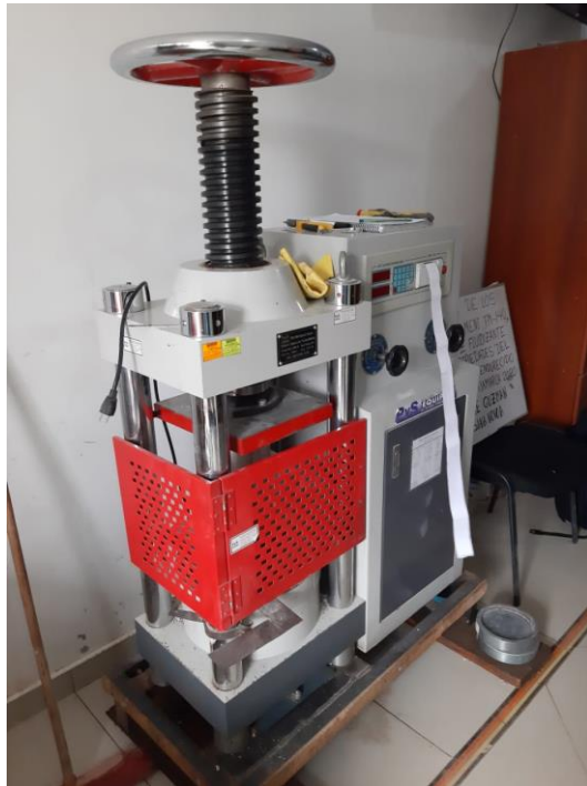
Prensa Hidráulica para romper las muestras de concreto
