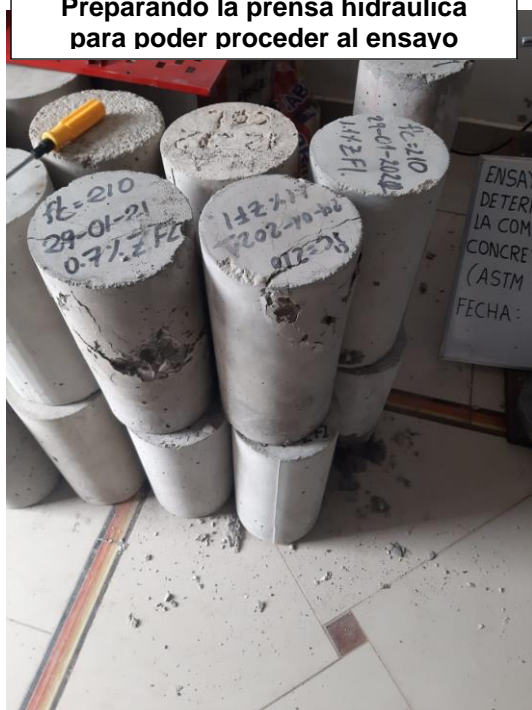
Muestra de concreto fracturadas de los esfuerzos
