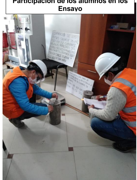
Medición de diámetro de muestras de concreto
