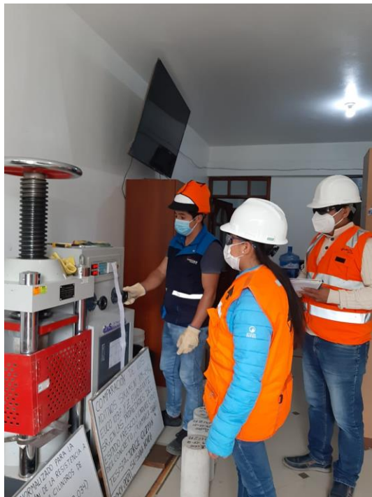
Preparando la prensa hidráulica para poder proceder al ensayo
