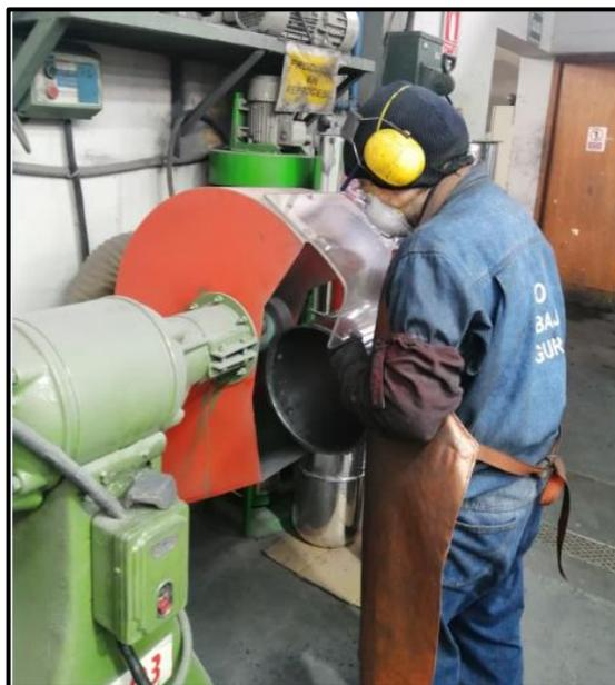
**Figura 32:** Esmerilado de olla defectuosa
