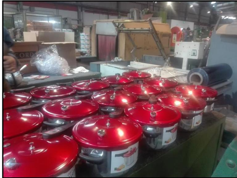
**Figura 23:** Ollas a presión ensambladas pre-plastificado
