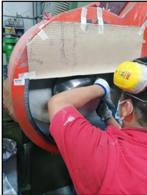
**Figura 38:** Lijado de cuerpo de Olla a presión
