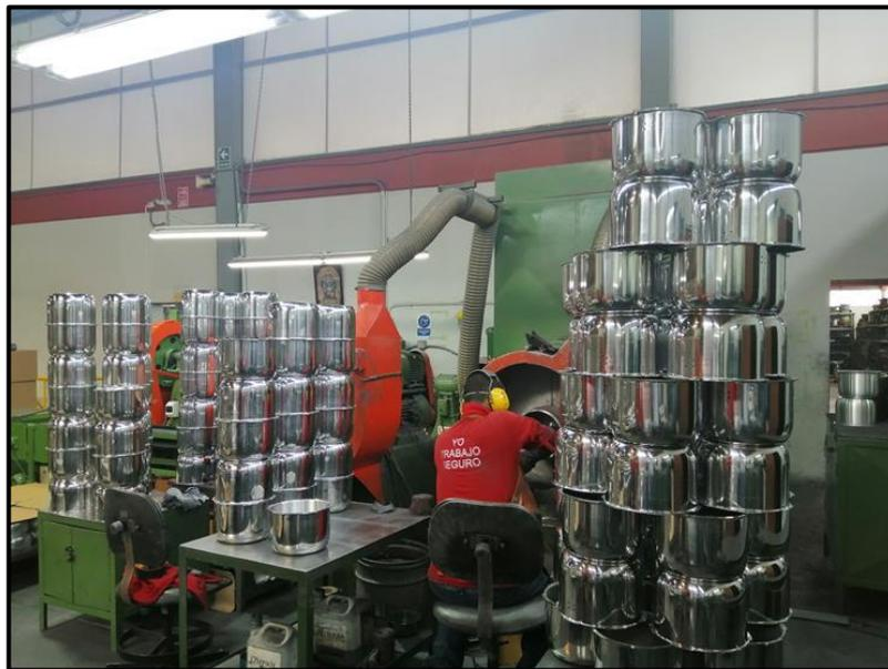
**Figura 22:** Ollas a presión en proceso de lijado
