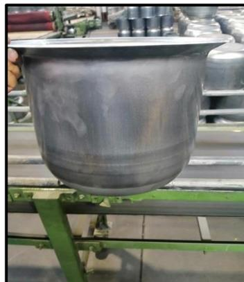
**Figura 17:** Olla post-2do prensado
