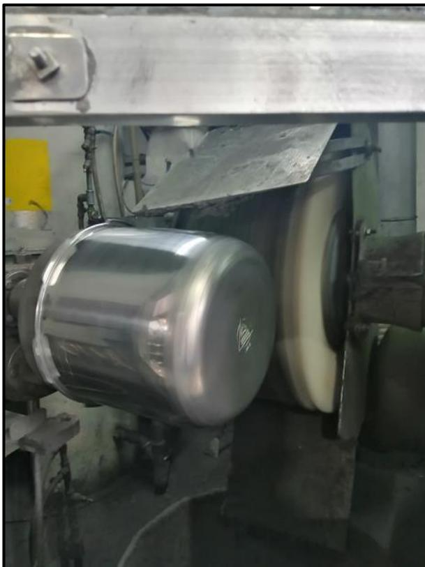
**Figura 20:** Olla a presión en proceso de pulido
