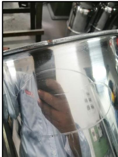
**Figura 30:** Identificación de defecto (ralladura)
