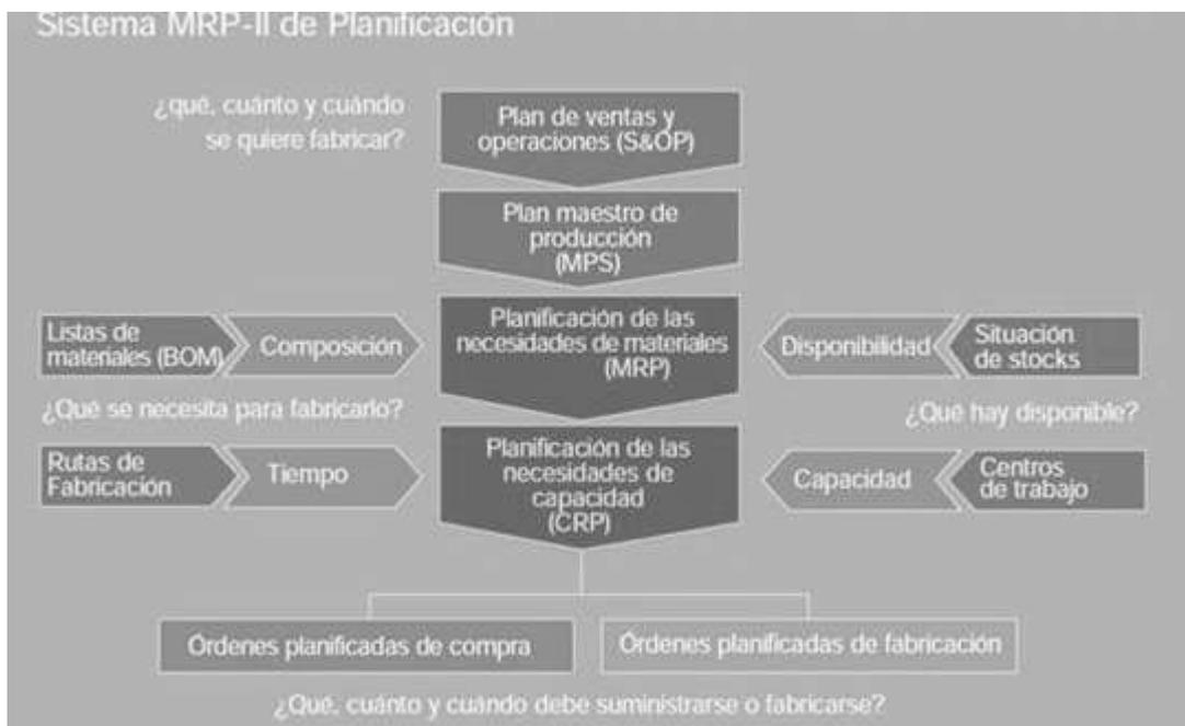
Figura 4. Sistema MRP-II de Planificación.
