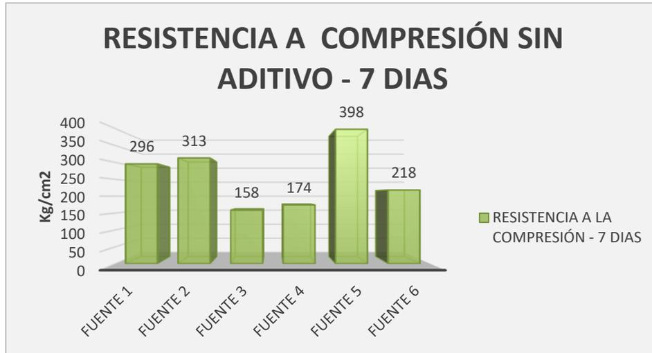
Figura 22: Resistencia a Compresión del concreto sin aditivo en 7 días de fraguado.
