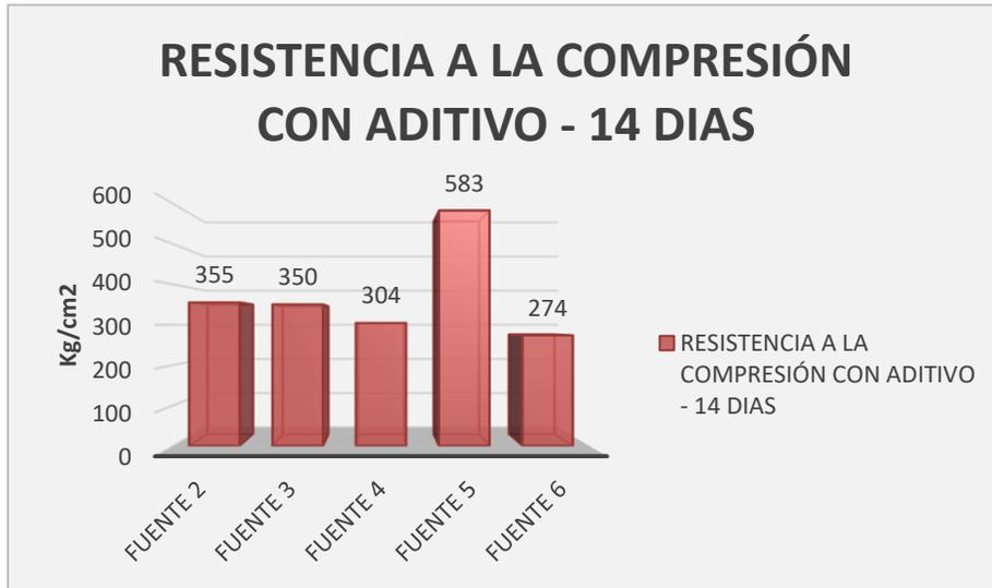
Figura 26: Resistencia a Compresión del concreto con aditivo en 14 días de fraguado.
