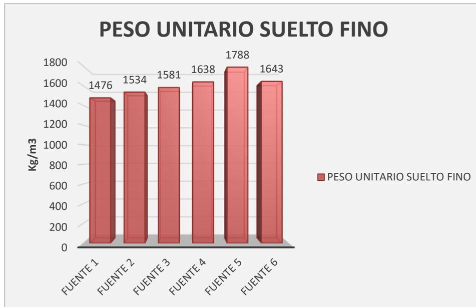
Figura 16: Peso Unitario Suelto del agregado Fino tomado de las fuentes de estudio.
