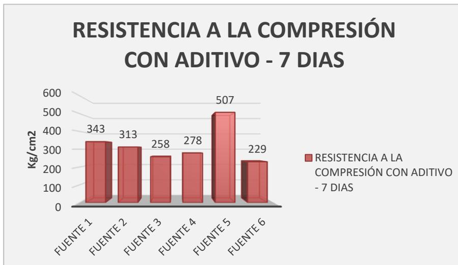
Figura 25: Resistencia a Compresión del concreto con aditivo en 7 días de fraguado
