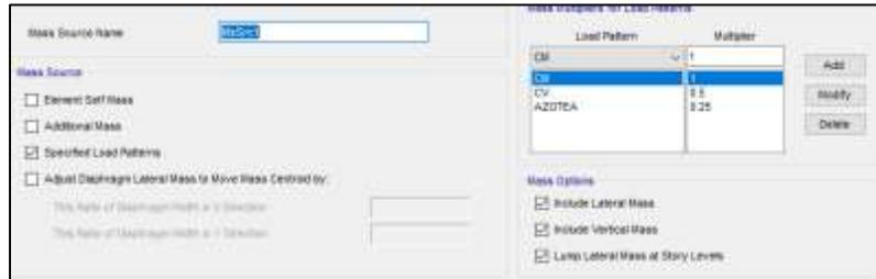
Figura 33. Masa sísmica de la estructura, desarrollado en ETABS.
