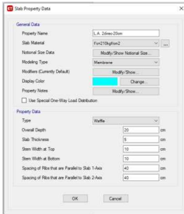
Figura 27. Definición de la losa en 2 direcciones.
