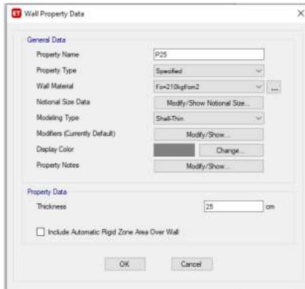
Figura 29. Definición de los muros de concreto.
