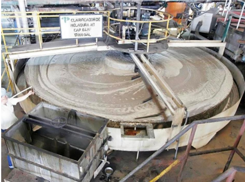
Figura 8: Clarificación de jarabe por flotación.
