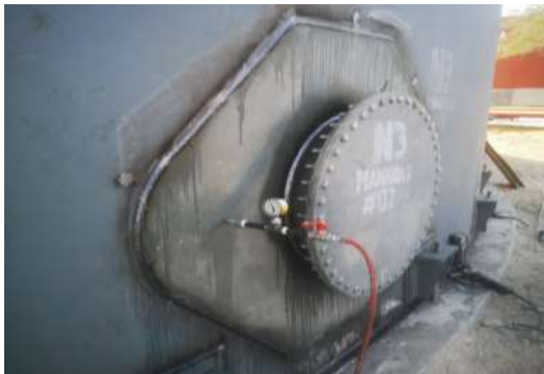
Figura 44. Prueba de hermeticidad
