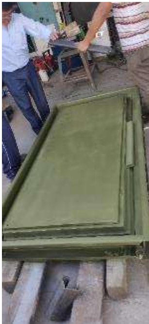
Fabricación de Puerta de Bóveda, Pintado con Zincromato
