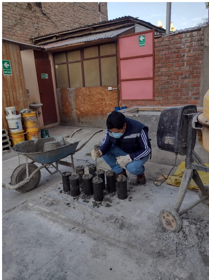
Figura N° 35: Elaboración de probetas de concreto
