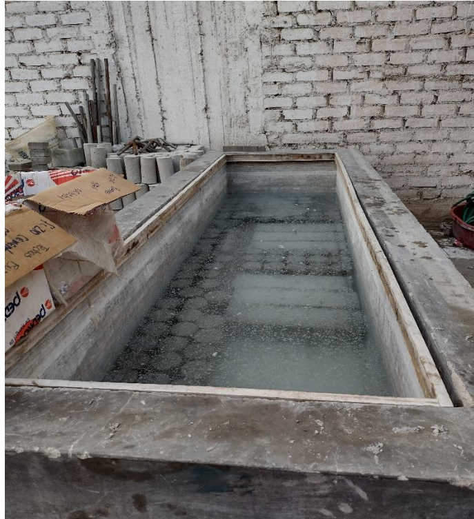
Figura N° 38: Curado de las probetas de concreto
