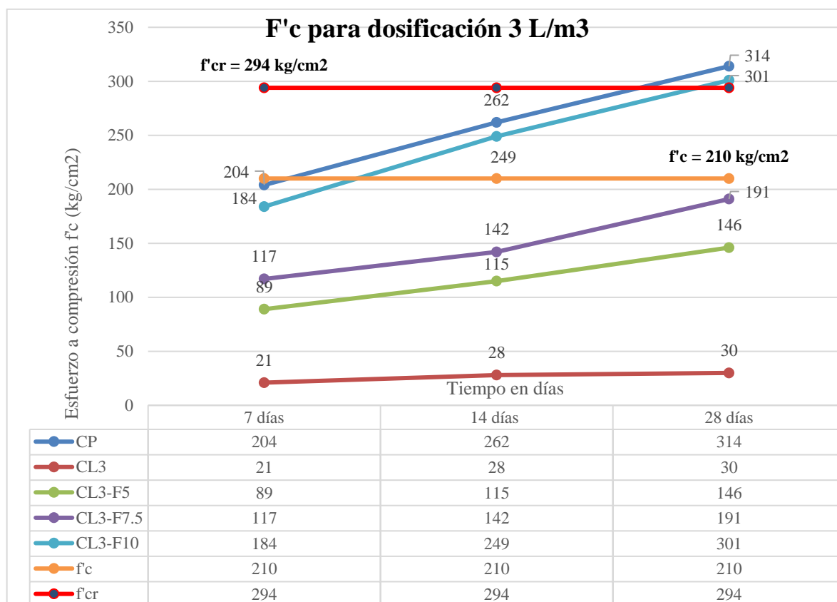
Figura N° 22: Resistencia a la compresión para todas las dosificaciones de 3L/m 3 de aditivo espumante.
