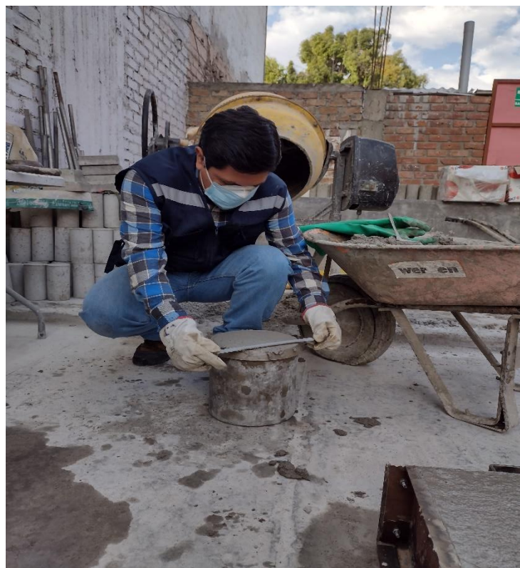
Figura N° 37: Enrasado final para el ensayo de Peso Unitario y % de aire
