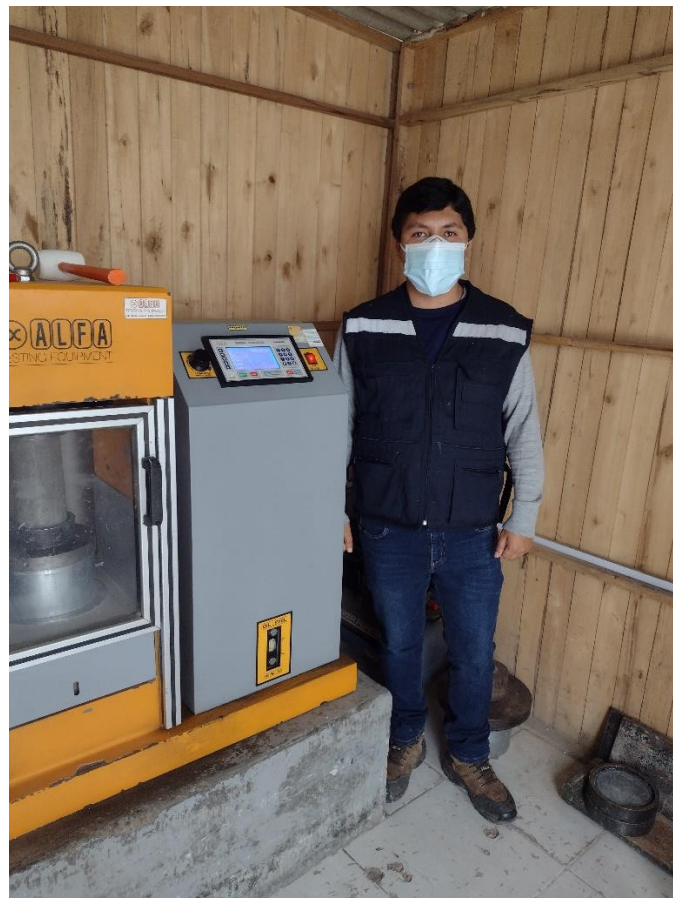
Figura N° 39: Ensayo de resistencia a la compresión
