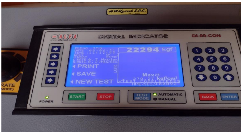
Figura N° 42: Resistencia máxima que alcanzó el diseño CL2-F7.5 a los 28 días de curado
