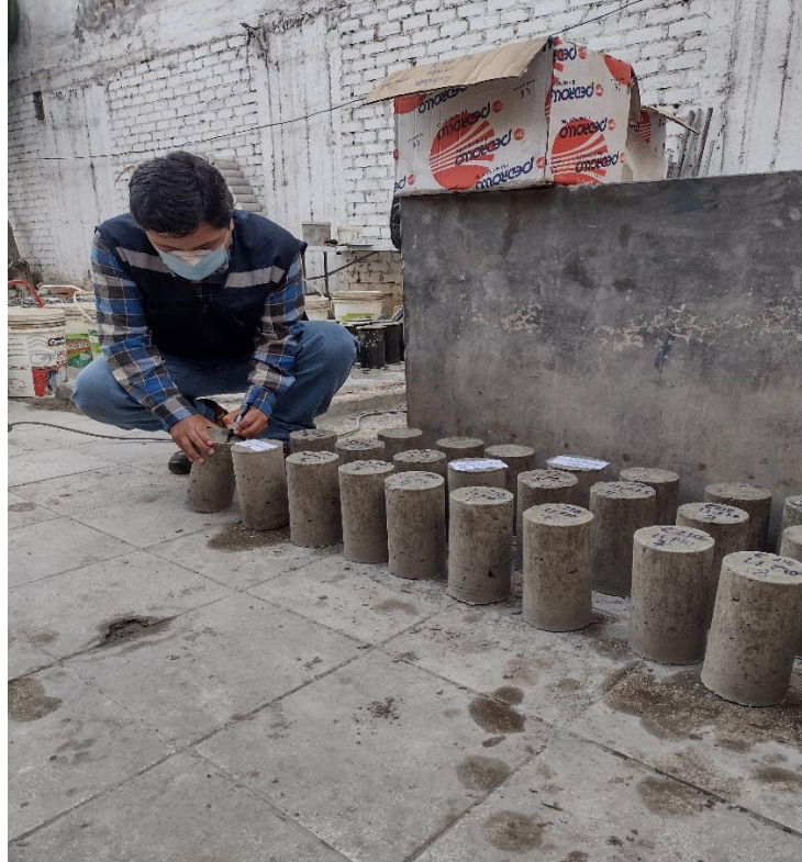
Figura N° 36: Desmoldado y codificación de los testigos de concreto
