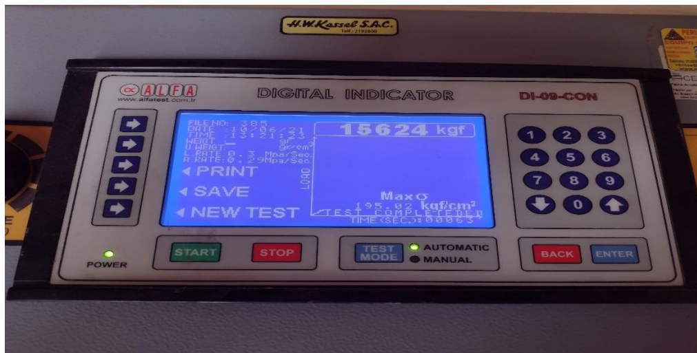
Figura N° 41: Resistencia máxima que alcanzó el diseño CL3-F7.5 a los 28 días de curado
