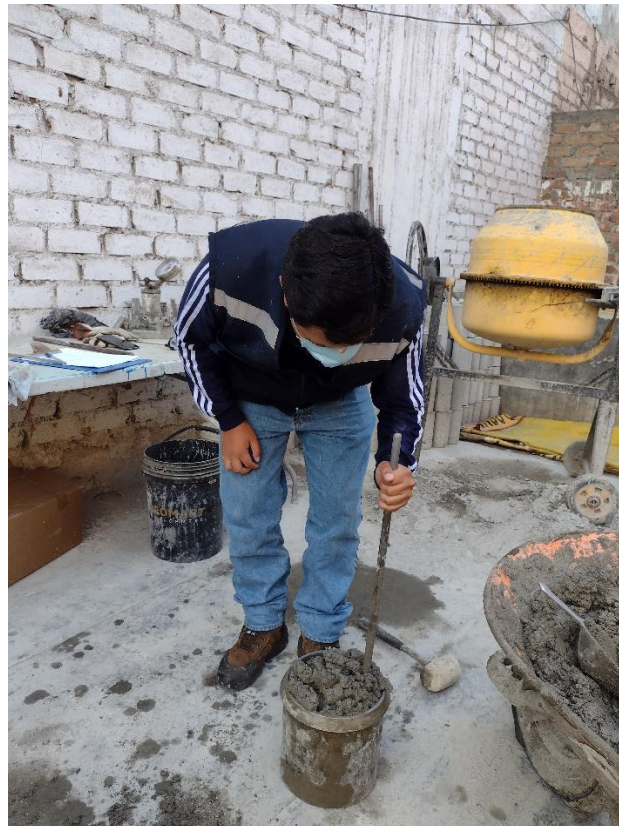
Figura N° 33: Varillado del recipiente para el ensayo de peso unitario
