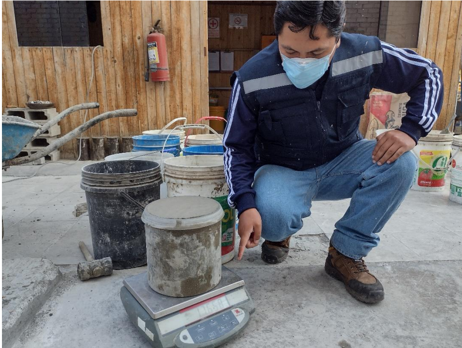
Figura N° 34: Comprobación y registro del Peso Unitario
