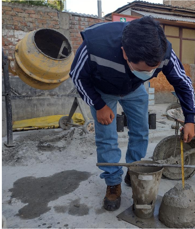
Figura N° 32: Verificación del asentamiento del concreto
