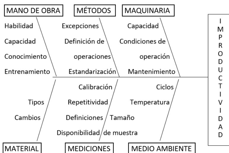
Fig. 1: Diagrama de Ishikawa aplicado para determinar la causa del problema de producción
