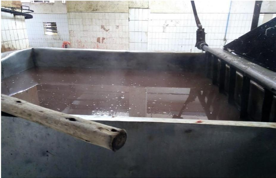
Nota. el proceso porcino, la paila es de acero inoxidable de 168cm de largo, 80cm de ancho, 61cm de alto, de 3mm de espesor y está conectada al caldero en un extremo tiene un termómetro para verificar la temperatura. Fuente: el camal.
