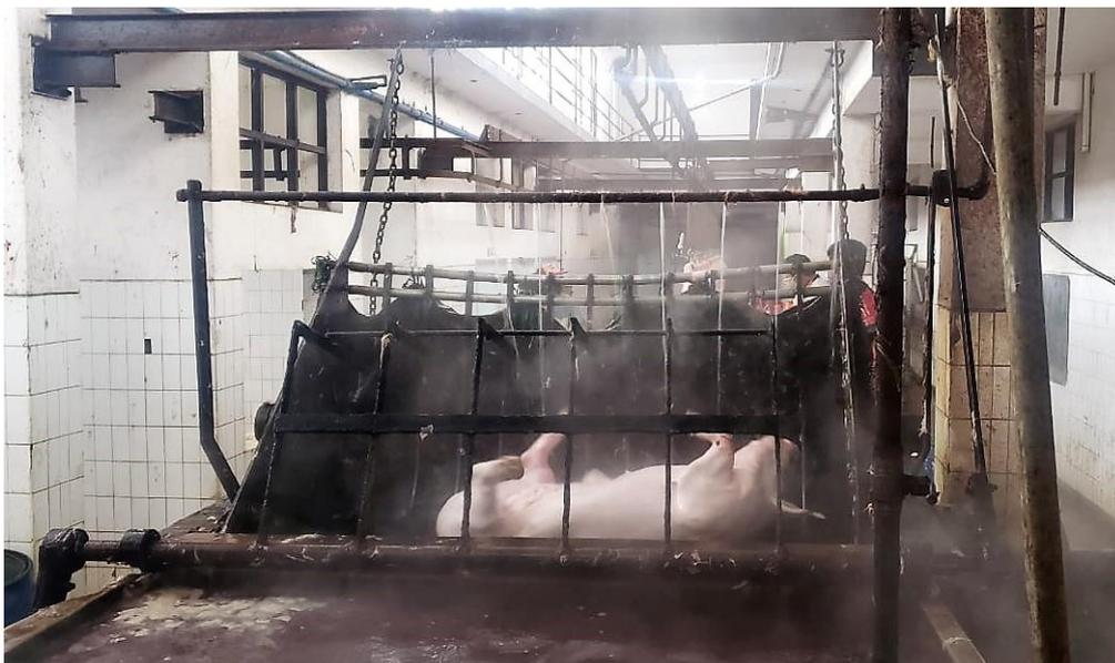
Nota. Peladora de cerdos es horizontal, el depilado es uno a uno con un raspador de caucho sintético, soporta un cerdo de hasta 250kg aprox., también cuenta con un tubo de agua a chorro para facilitar el depilado. Fuente: el camal.
