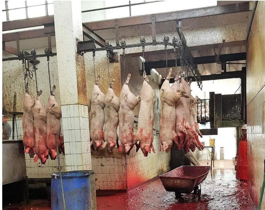
Nota. Transporte Aéreo de aluminio con cadena para suspender a los especímenes. Fuente: camal
