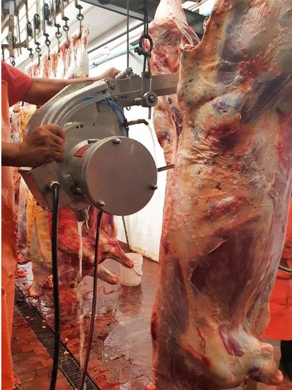
Nota. Sierra potente de acero inoxidable, para dividir las reses con facilidad y se alimenta de electricidad y aire comprimido. Fuente: camal.
