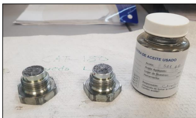
Figura 60. Tapones magnéticos de ruedas delanteras, nos está indicando desgaste prematuro al encontrar regular cantidad de partículas metálicas.
