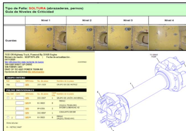
Figura 55. Inspección del cardan PTO.
