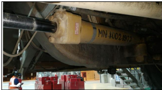
Figura 46. Inspección de cilindro de dirección.
