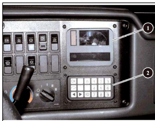
Figura 33. Se muestra el módulo del centro de mensajes del Sistema de Administración de Información Vital (VIMS) (1) y el teclado del módulo (2).
