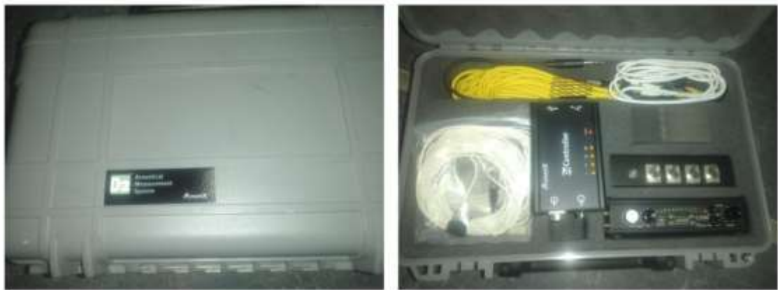
Figura 07. Equipo de calibración sonoro D2 empleado para el proceso de ecualización al interior de una sala de cine.
