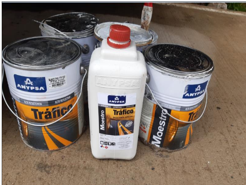
Figura 8: Material utilizado para el pintado de señalización de tránsito vehicular y peatonal.
